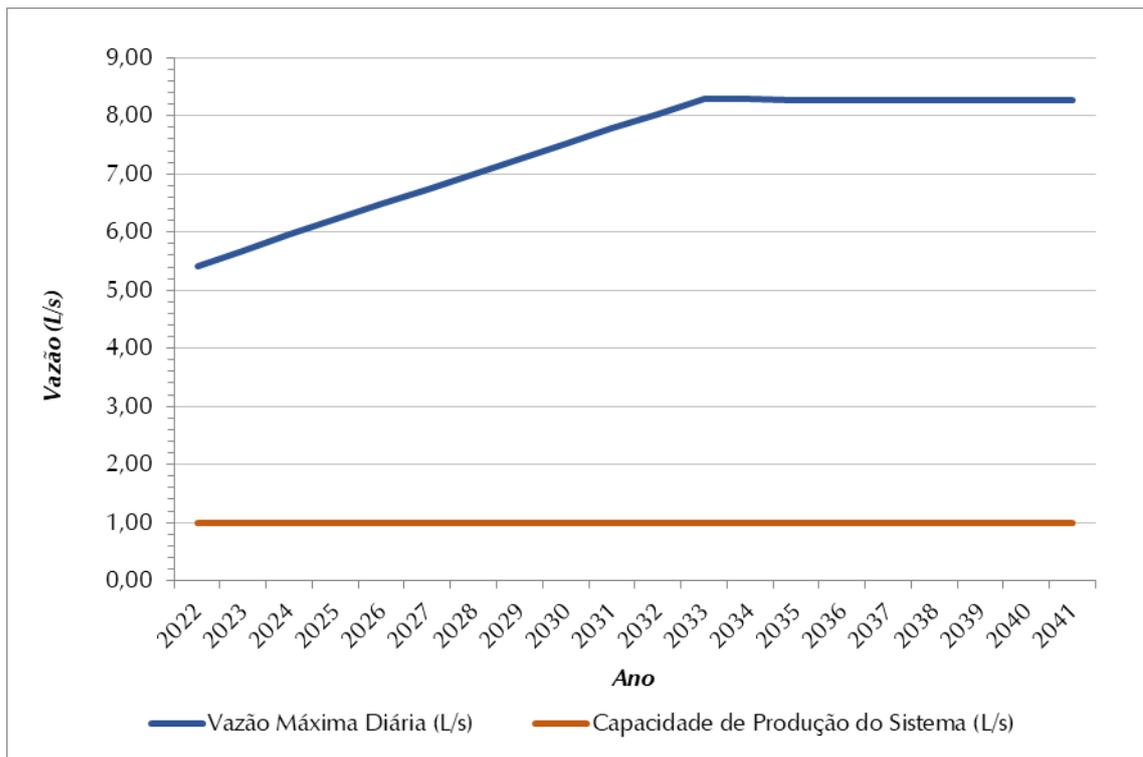
**Figura 8.1 – Vazão Máxima Diária (m³) x Capacidade de Produção do Sistema (m³) SAA Sede**
