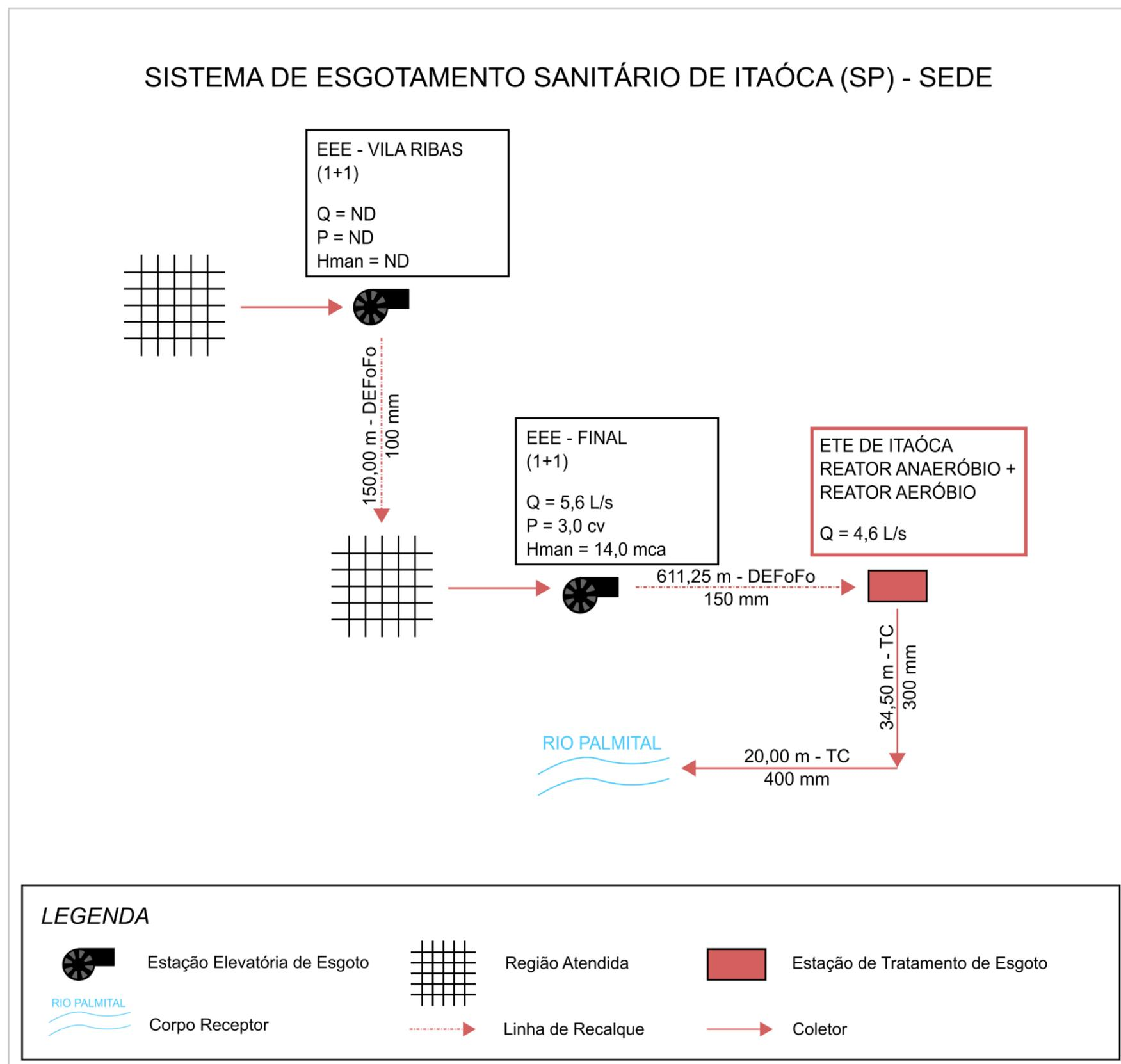
Figura 4.3 – Croqui do Sistema de Esgotamento Sanitário da Sede de Itaóca
