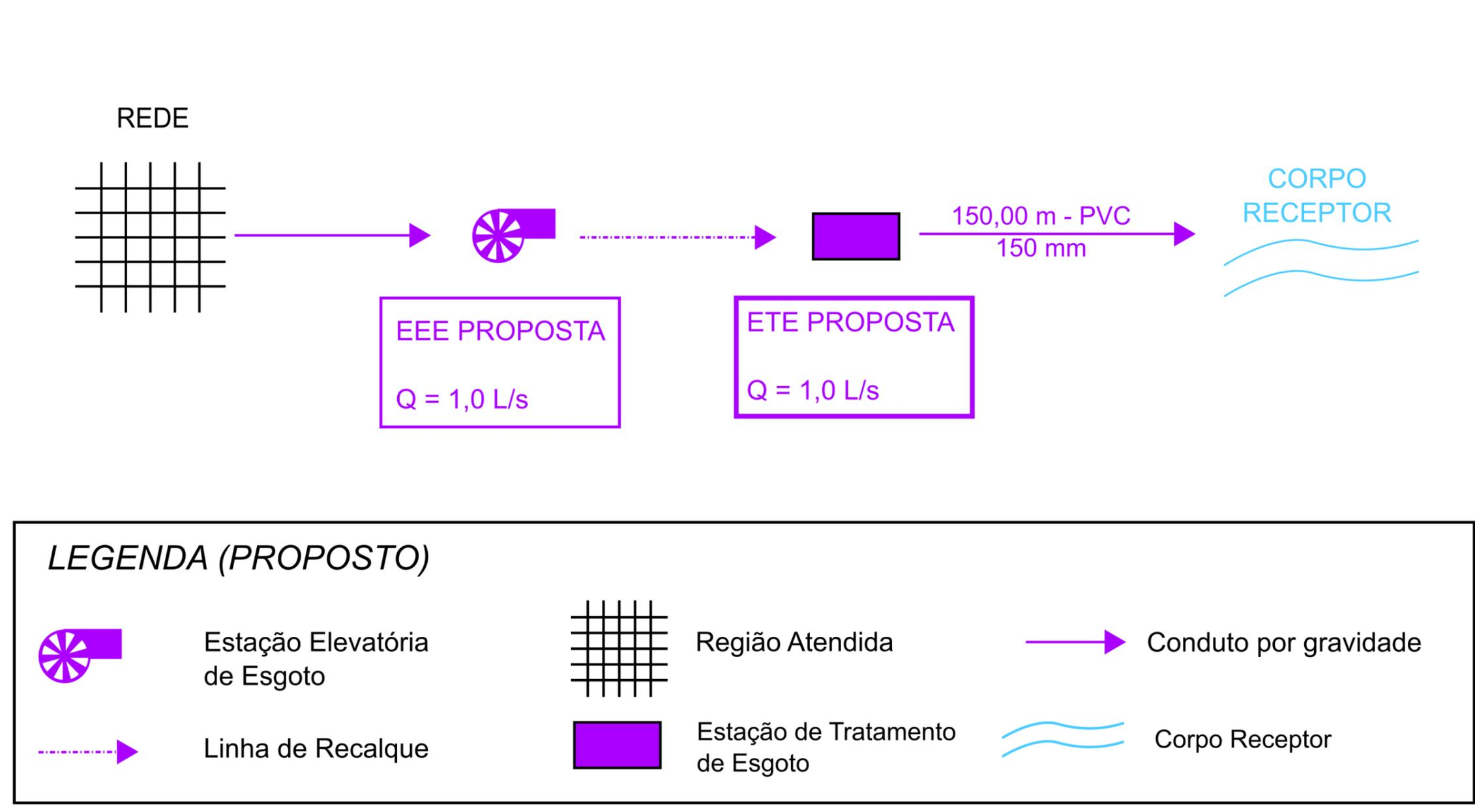
Figura 10.3 – Croqui do sistema de esgotamento sanitário proposto para o bairro Caraças
