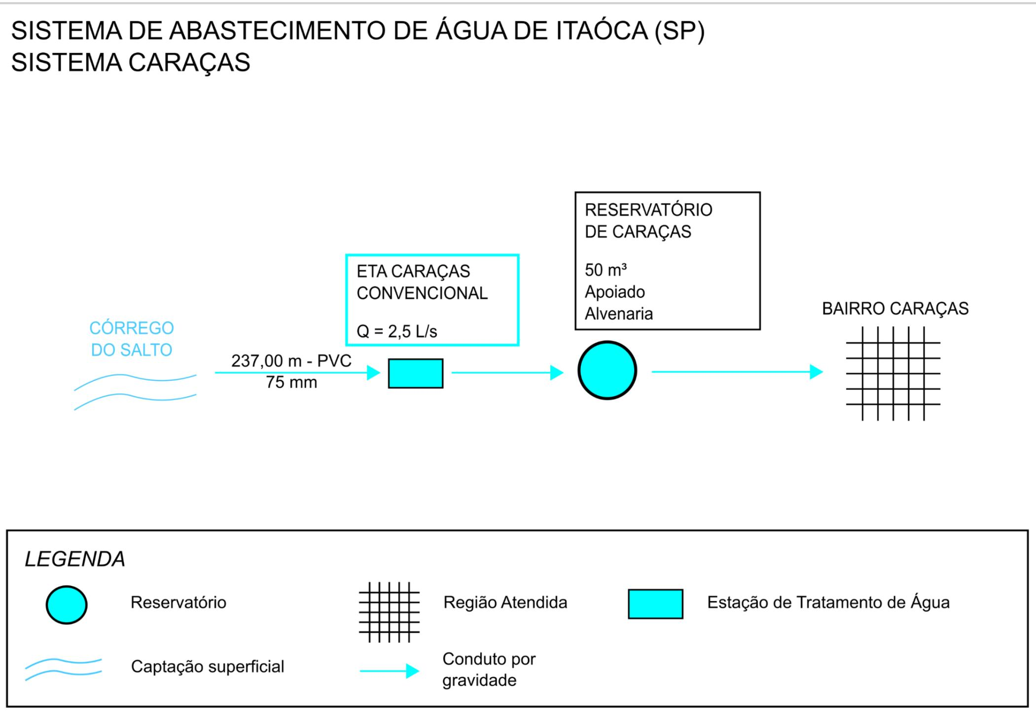
Figura 4.2 – Croqui do Sistema de Abastecimento de Água Caraças
