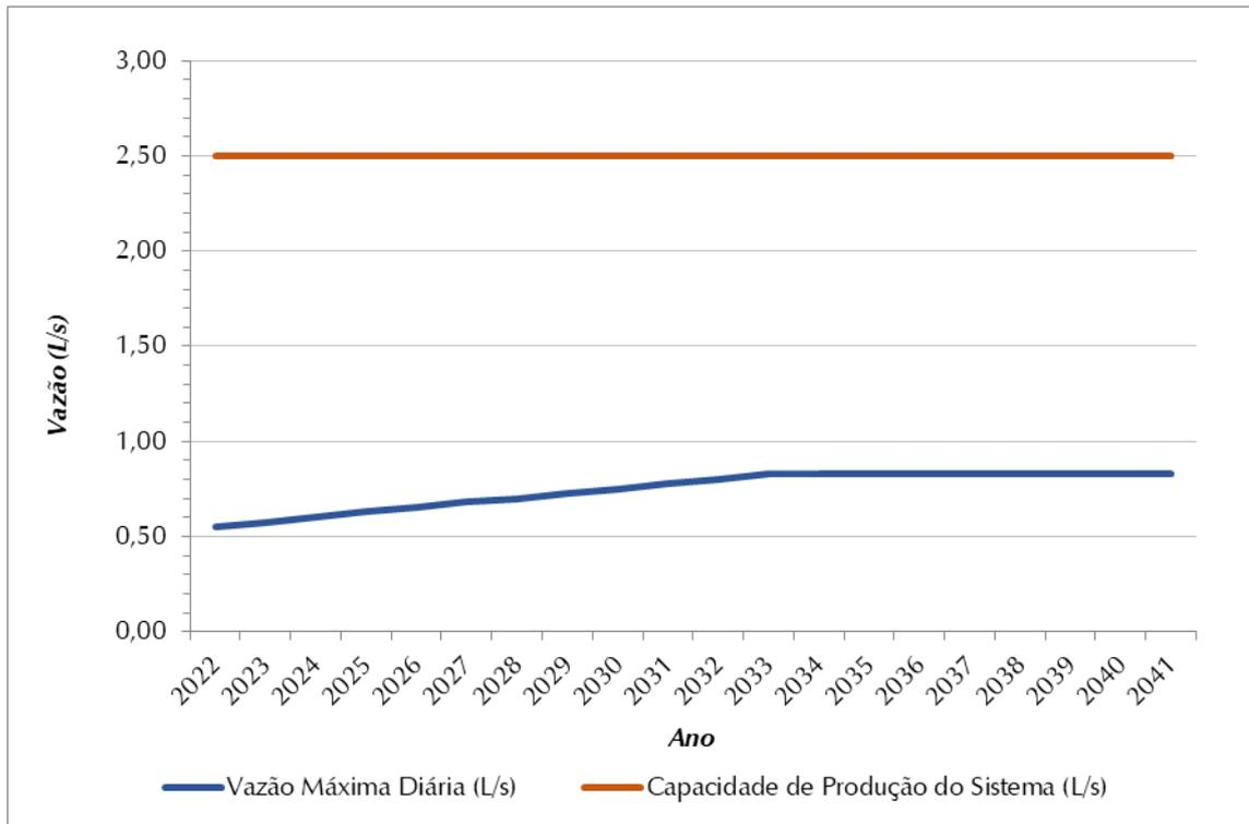
Figura 8.3 – Demandas Máximas Diárias (L/s) X Vazão Captada (L/s) – SAA Caraças
