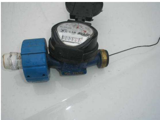
Figura 39. Hidrômetro com arame.
