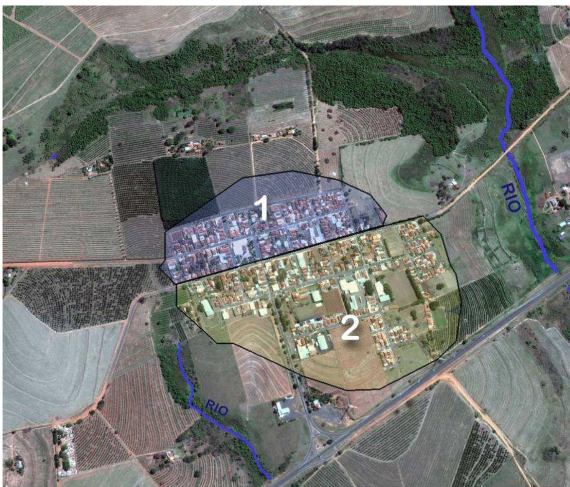
Figura 15. Bacias de esgoto sanitário existentes no Distrito de Nova América.
