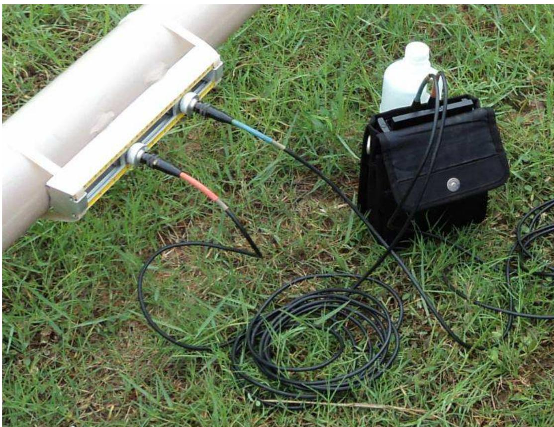
Figura 12. Ilustração da conexão entre os transdutores e a Unidade Eletrônica.
