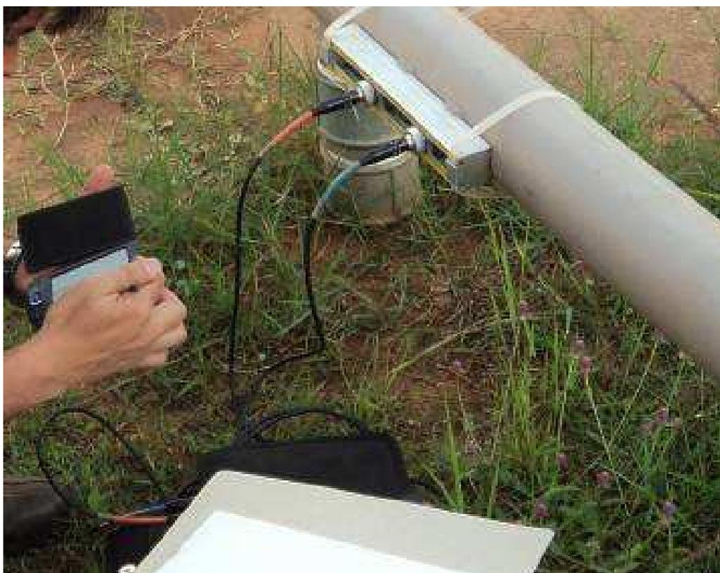
Figura 09. Ilustração da comunicação entre o Palm e Unidade Eletrônica.
