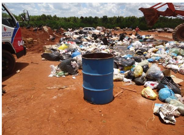
Figura 8.1.13. Tambor de 200 litros utilizado na amostragem.
