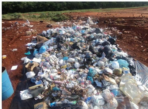
Figura 8.1.20. Resíduos espalhados sobre a lona plástica para o quarteamento.
