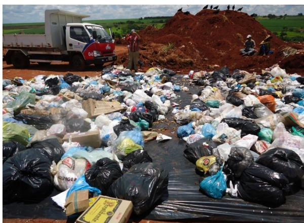
Figura 8.1.9. Processo de quarteamento dividindo a massa de resíduos em duas partes.
