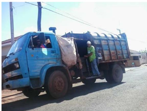
Figura 8.1.71. Detalhe do caminhão VW 11.140 utilizado na coleta (inadequado).
