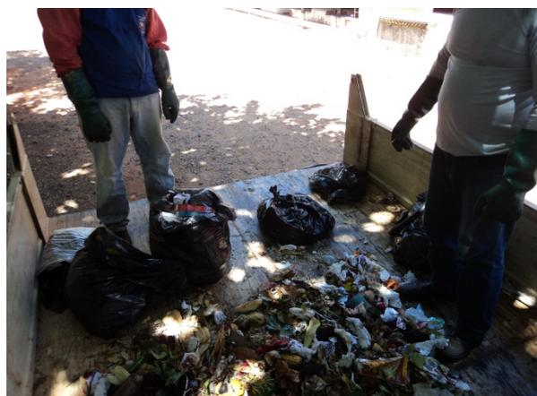
Figura 8.1.28. Sacos plásticos com diferentes tipos de materiais e massa de resíduos sendo separada.
