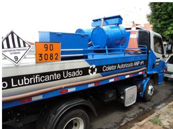
Figura 8.6.1. Caminhão coletor de óleo lubrificante usado durante a coleta.
