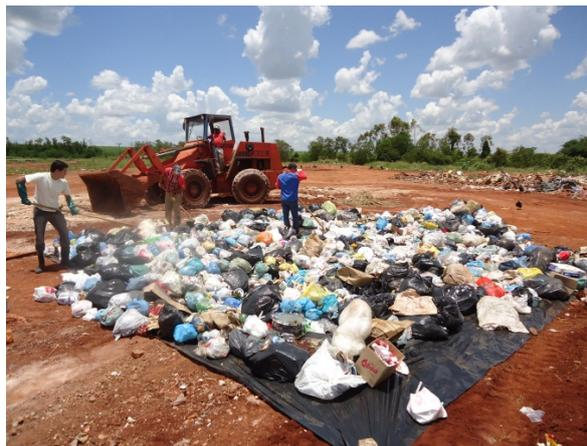
Figura 8.1.8. Resíduos sendo espalhados sobre a lona plástica.
