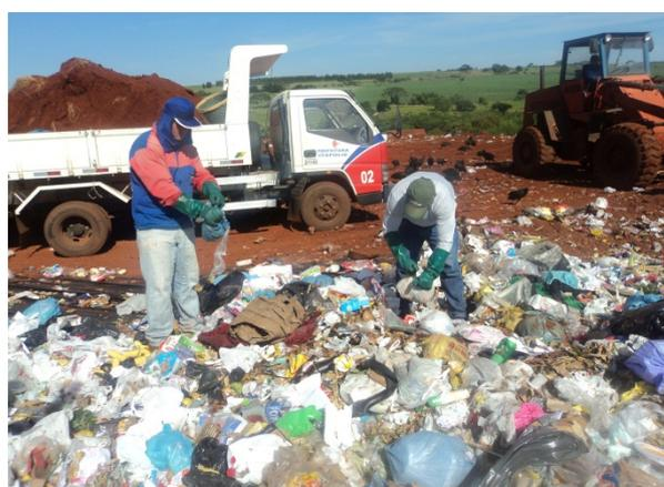
Figura 8.1.24. Saquinhos plásticos sendo rasgados para homogeneização dos resíduos.
