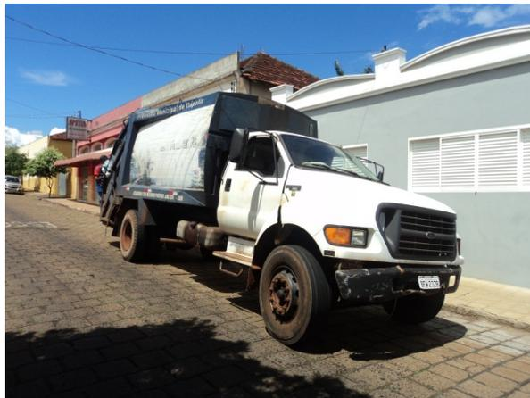
Figura 8.1.68. Caminhão coletor-compactador realizando a coleta.
