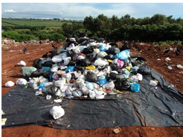
Figura 8.1.30. Descarregamento dos resíduos em lona plástica para não haver influência de
