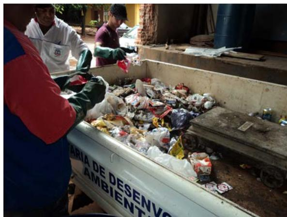
Figura 8.1.61. Separação dos resíduos por tipo de material durante a sétima caracterização física.
