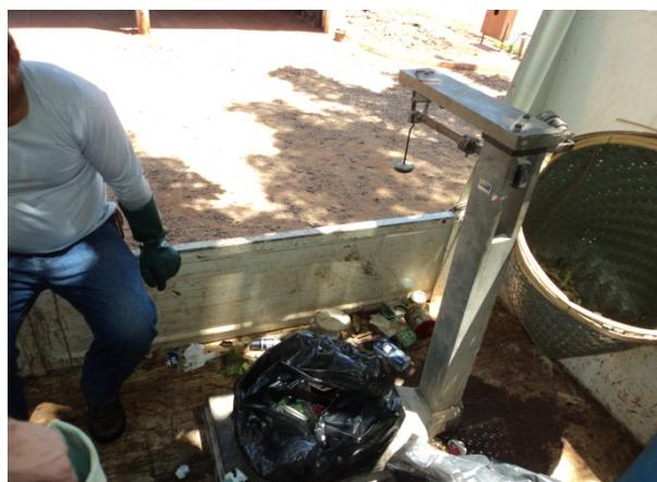
Figura 8.1.27. Pesagem dos materiais separados por tipos.
