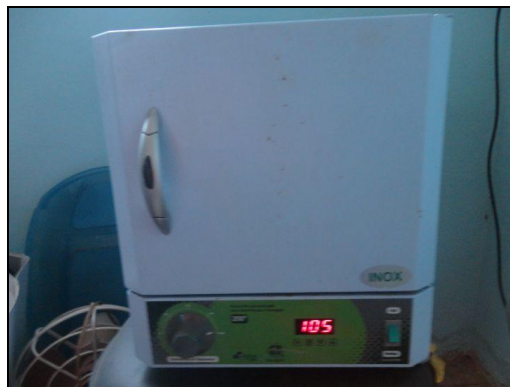
Figura 195 - Figura 1. Amostra de 2L de resíduos sendo pesada e posteriormente já inserida em estufa a 105°C.
