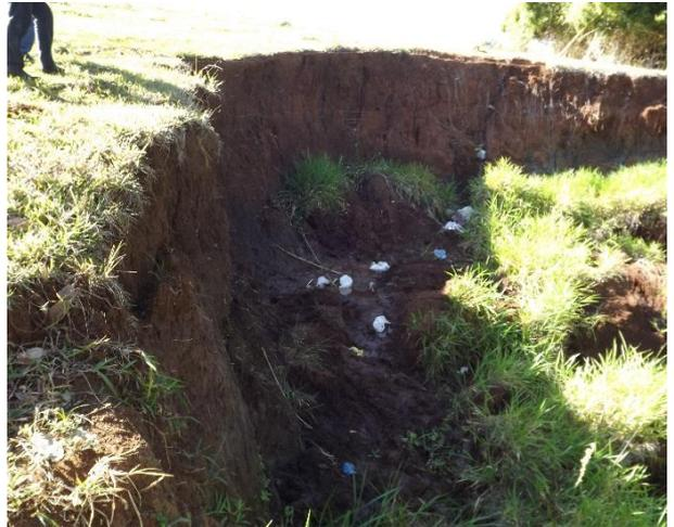
**Foto 3.17 – Detalhe da presença de resíduos sólidos carregados pelas águas pluviais que escoam superficialmente até a voçoroca.**
