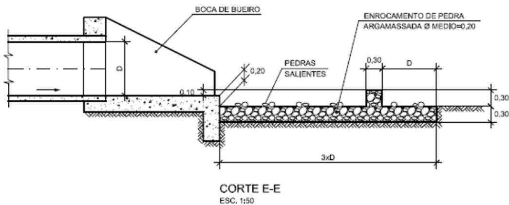
Ilustração 8.12 – Saída do canal de escoamento trapezoidal e dissipador de energia
