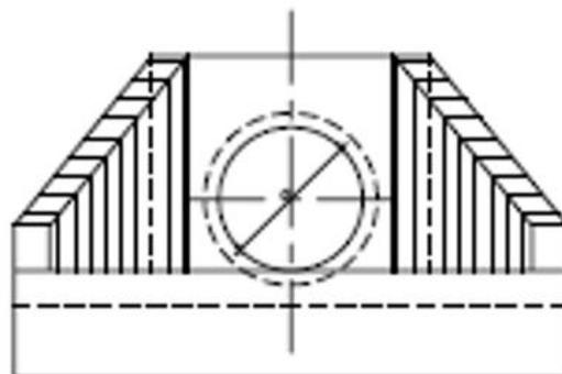
**Ilustração 8.2 – Vista frontal da boca de saída de bueiro simples tubular de concreto (BSTC)**
