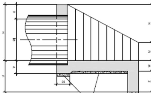
**Ilustração 8.4 – Corte da boca de saída de bueiro simples tubular de concreto (BSTC)**
