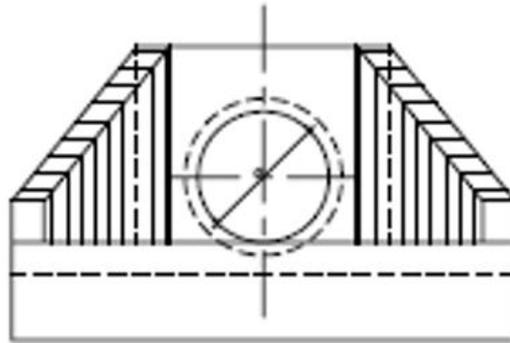
Ilustração 8.8 – Vista frontal da boca de saída de bueiro simples tubular de concreto (BSTC)
