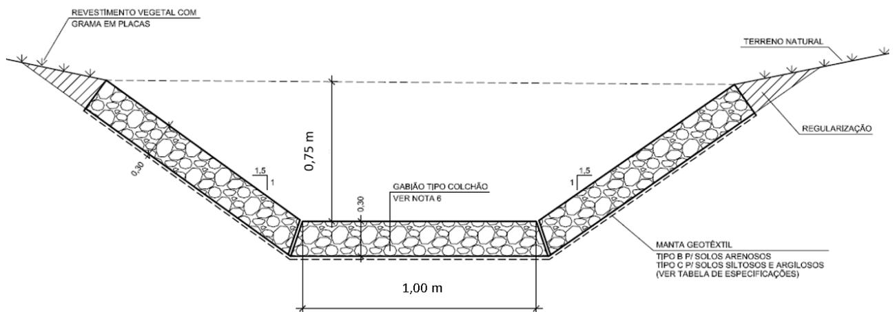
**Ilustração 8.5 – Seção planejada para o canal de escoamento trapezoidal em gabião**
