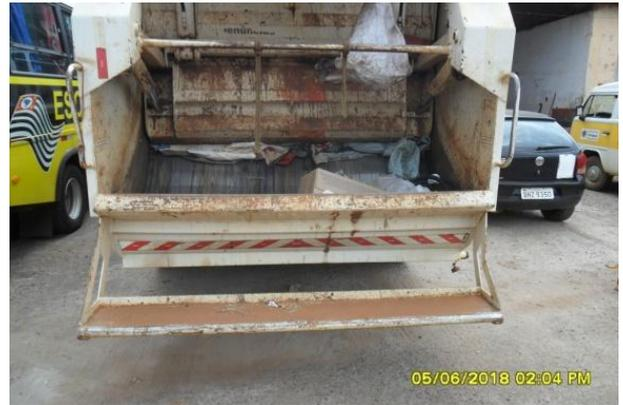
Foto 3.2 – Detalhe do caminhão coletor compactador utilizado na coleta regular
