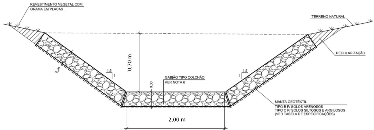
Ilustração 8.11 – Seção planejada para o canal de escoamento trapezoidal em gabião
