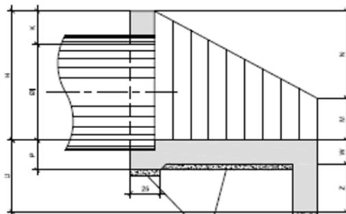
Ilustração 8.10 – Corte da boca de saída de bueiro simples tubular de concreto (BSTC)
