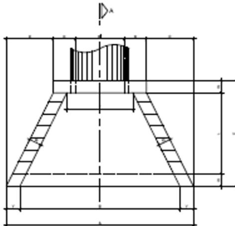
**Ilustração 8.3 – Vista superior da boca de saída de bueiro simples tubular de concreto (BSTC)**
