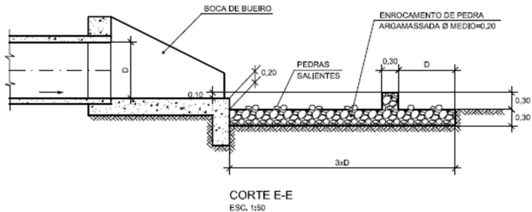
**Ilustração 8.6 – Saída do canal de escoamento trapezoidal e dissipador de energia**
