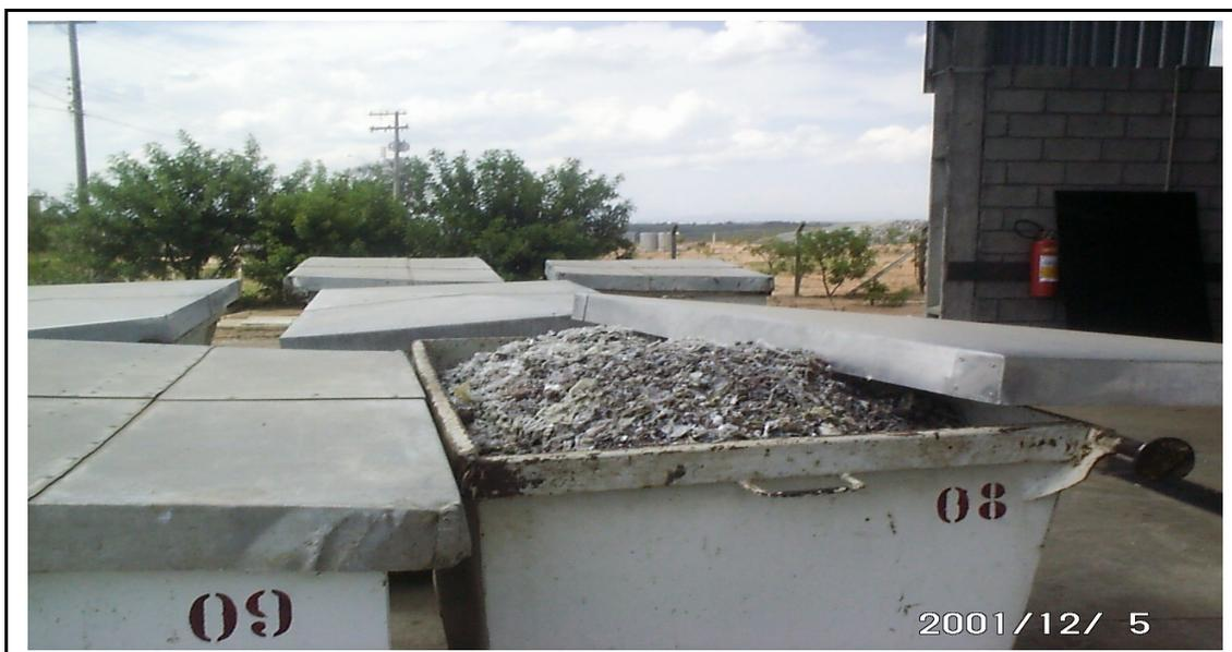
Foto 4.14 - Vista do pátio externo onde os carrinhos contendo os RSSS já desinfetados aguardam o transporte para o aterro sanitário onde os mesmos serão dispostos, observando-se os resíduos já descaracterizados como resíduos perigosos.
