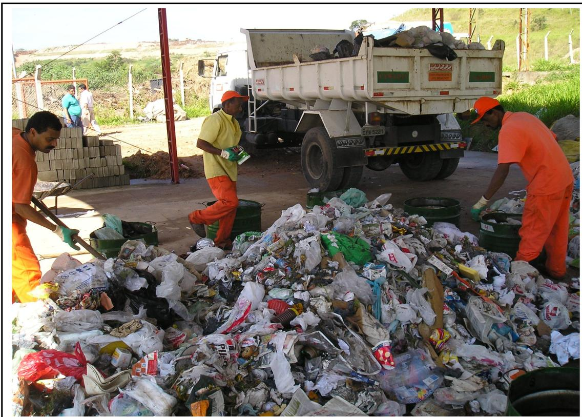
Foto 4.4. - Operação de homogeneização dos resíduos da amostra.
