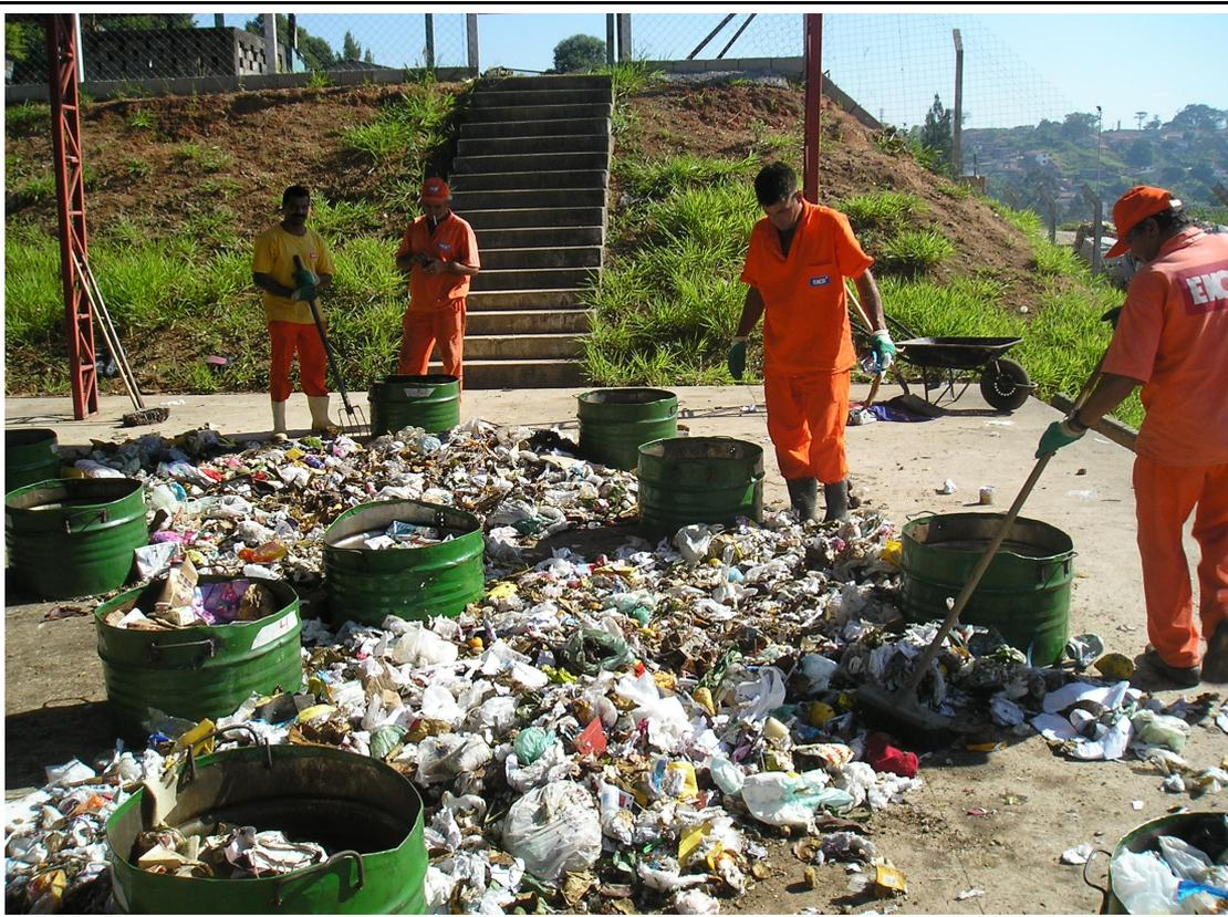
Foto 4.6. - Triagem dos componentes dos resíduos e colocação nos latões para serem pesados.
