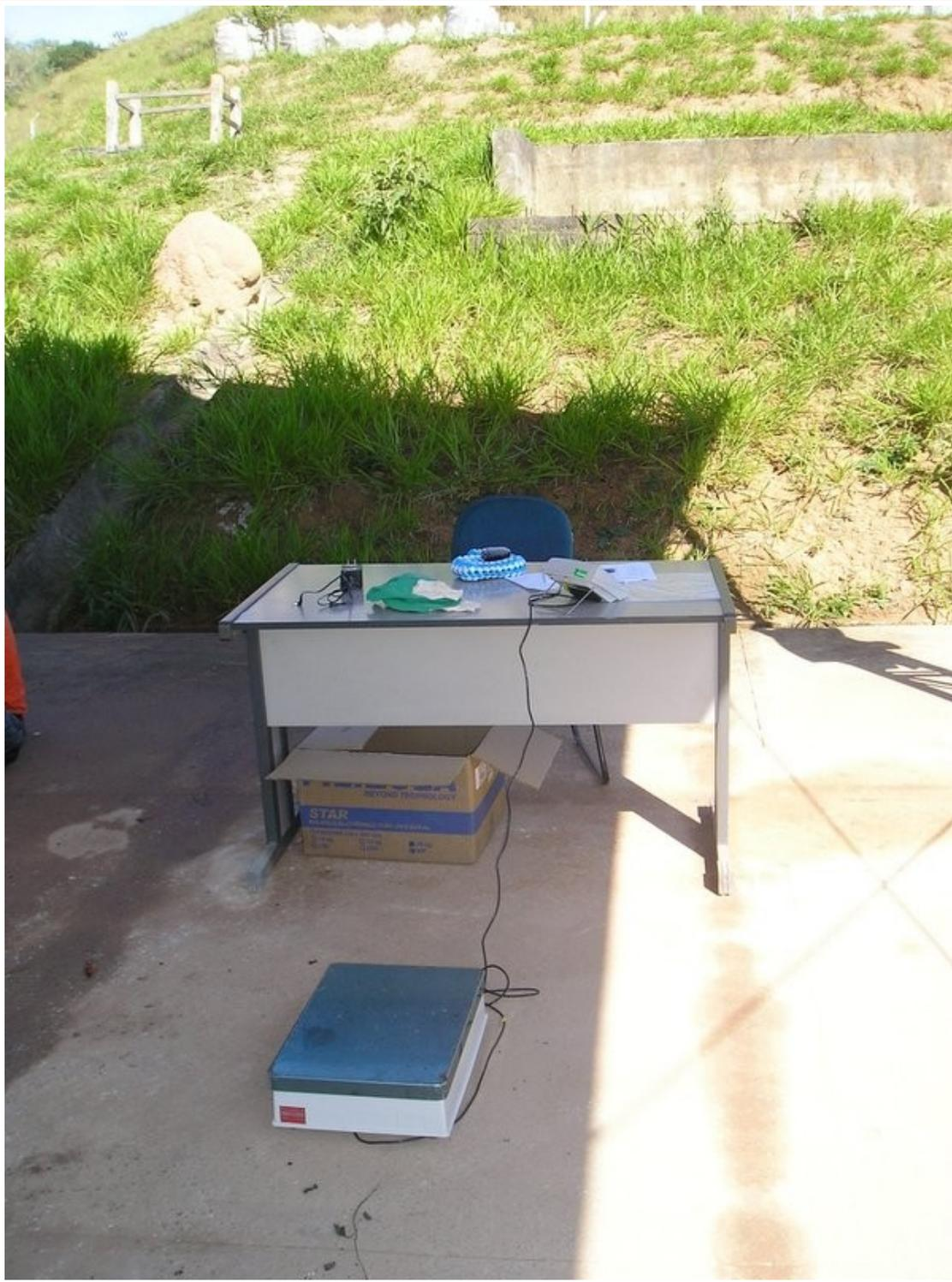
**Foto 4.7. - Balança eletrônica cedida pela ENOB Ambiental para a realização das pesagens dos componentes dos resíduos.**
