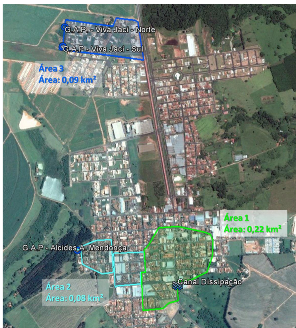
Figura 4.1 – Principais unidades do sistema de microdrenagem
