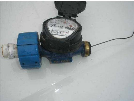
Figura 32. Hidrômetro com arame.
