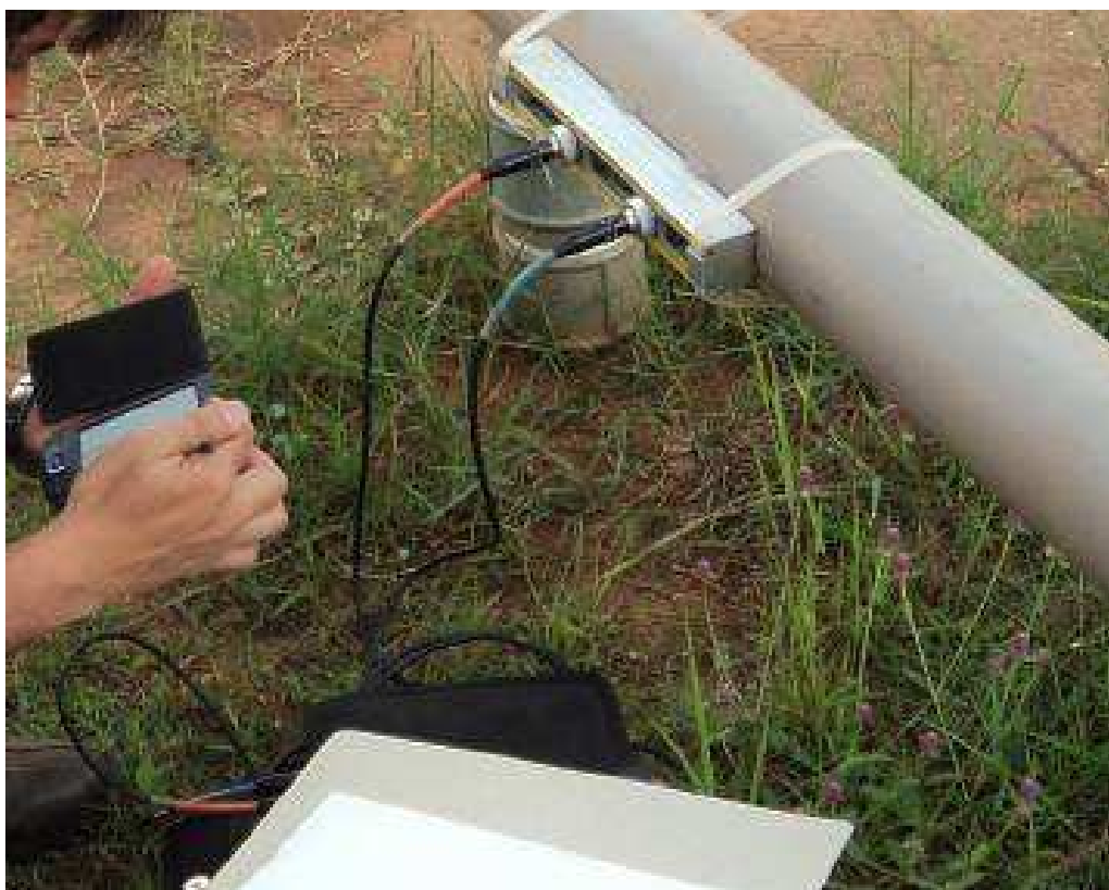
Figura 07. Ilustração da comunicação entre o Palm e Unidade Eletrônica.
