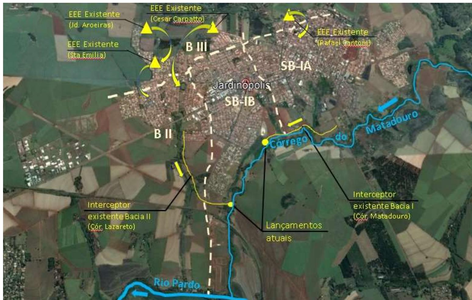
Ilustração 6.3 – Sistema de esgotamento sanitário existente
