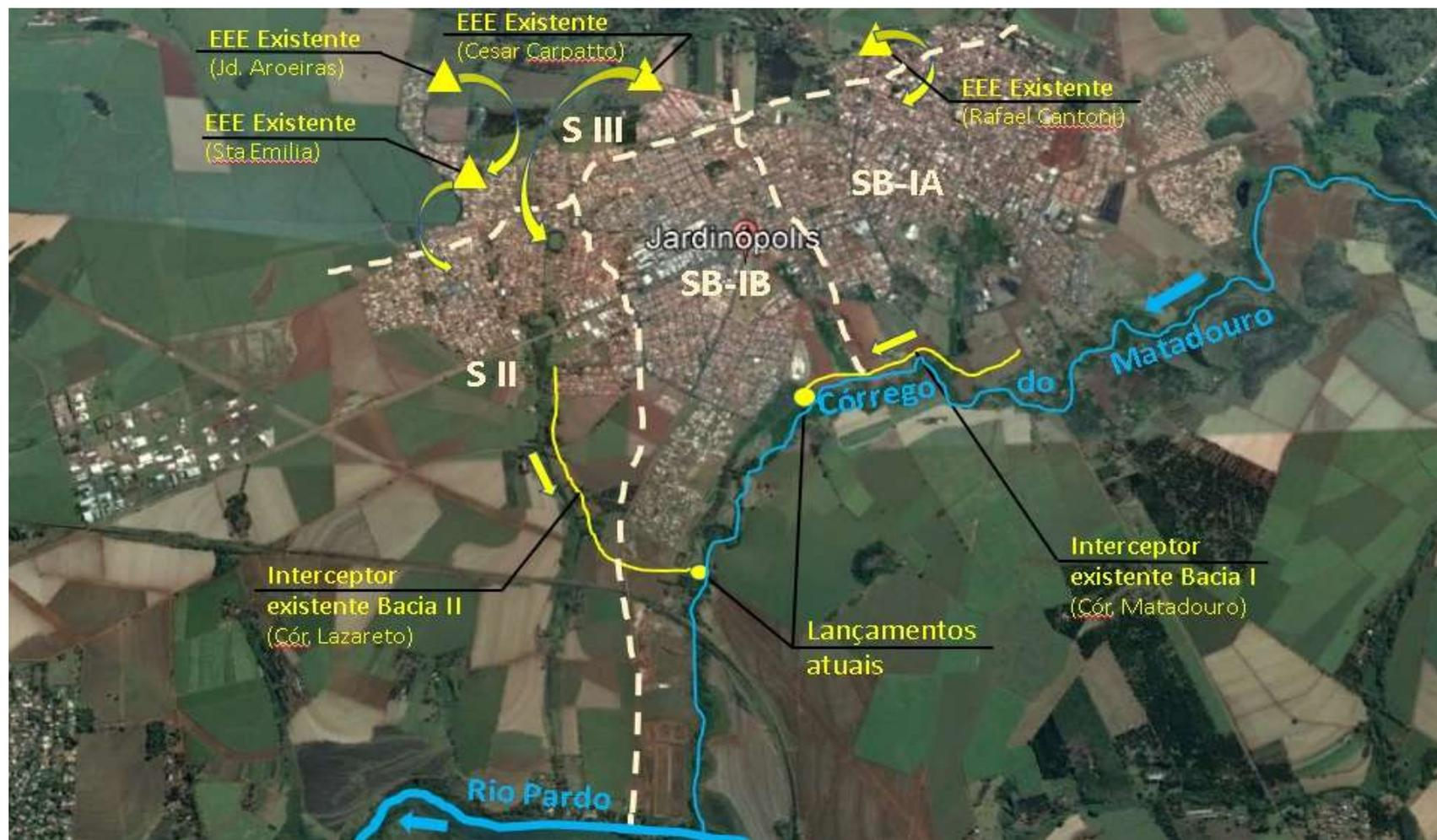
Ilustração 6.1 - . Sistema de esgotamento sanitário existente na sede
