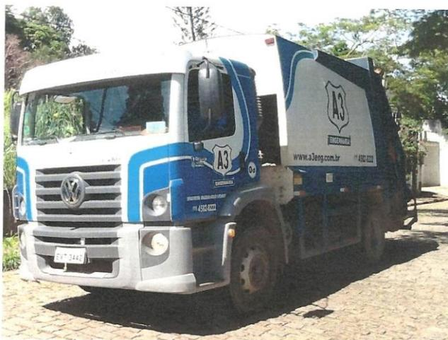
Figura 1 - Caminhão compactador da empresa A3 Engenharia utilizado na coleta de resíduos sólidos domiciliares em Jarinu.
