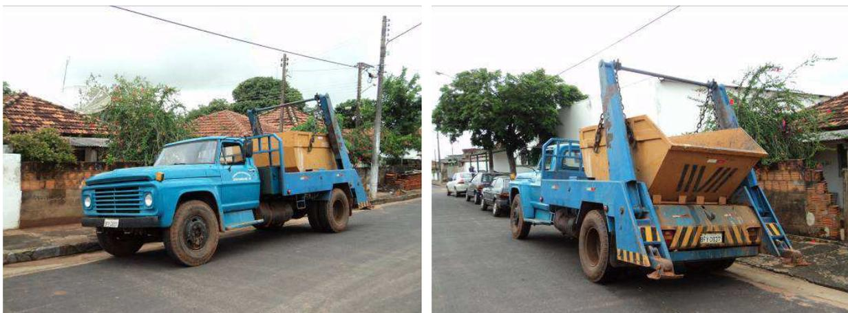
Figura 35. Caminhão – Coleta de resíduos da construção civil (RCC)
