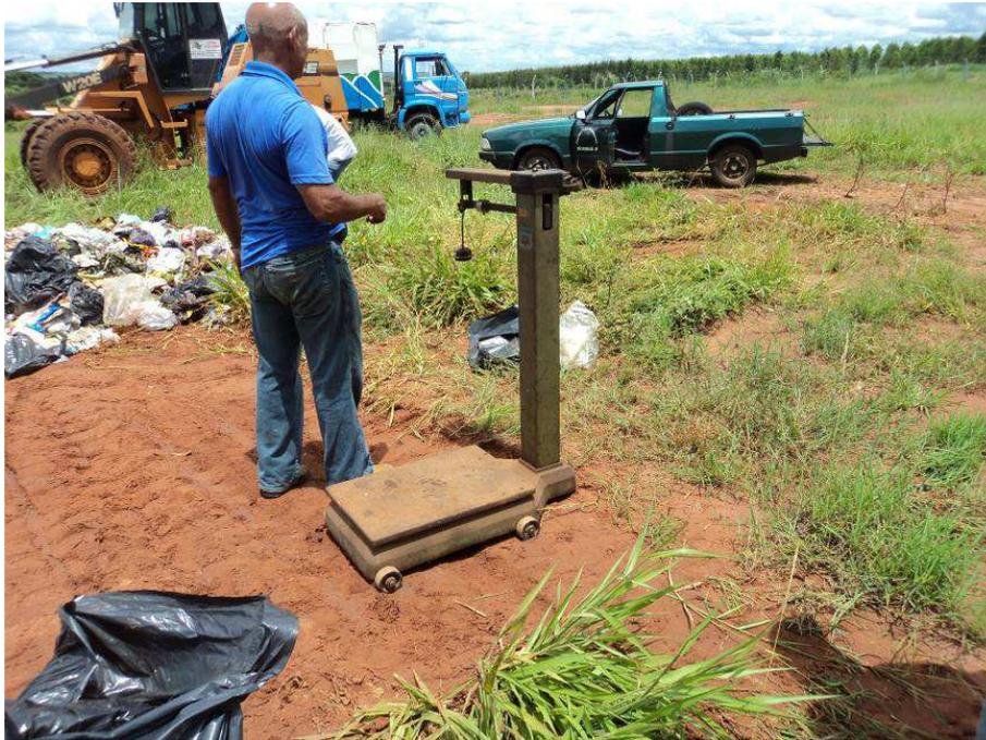
Figura 29. Balança utilizada para pesar os materiais segregados do resíduo sólido doméstico
