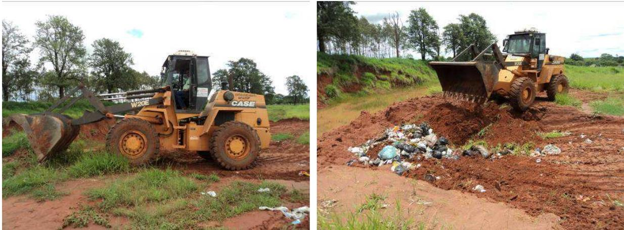
Figura 48. Trator do tipo Pá Carregadeira utilizado no aterro sanitário
