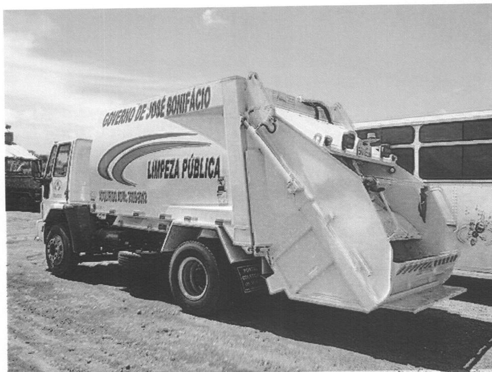
**Foto 1. Caminhão compactador de lixo com coletor**
