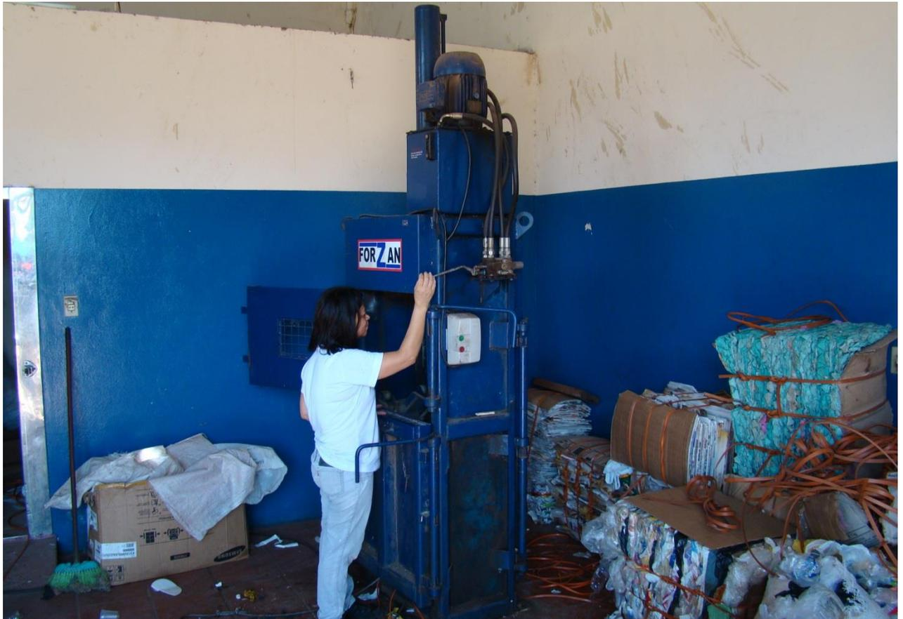
Imagem 27: Modelo de prensa para a compactação e enfardamento dos materiais recicláveis após sua separação.
