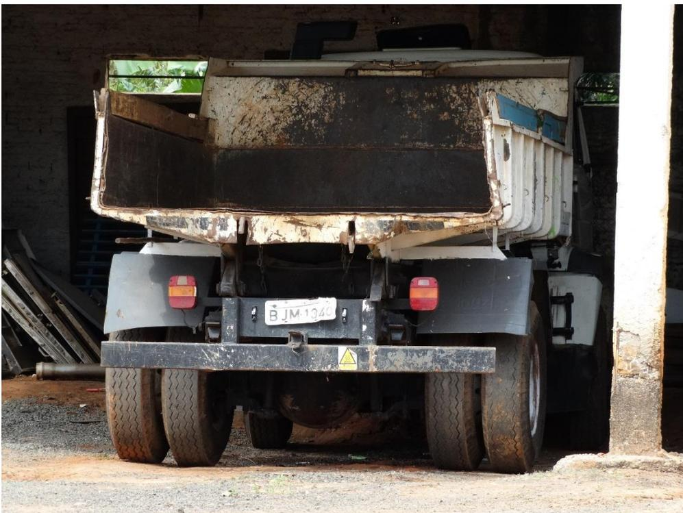
Imagem 24 – caminhão caçamba utilizado na coleta de recicláveis. Também pode ser usado um caminhão compactador para este tipo de coleta, porém não compactando/ prensando os materiais.
