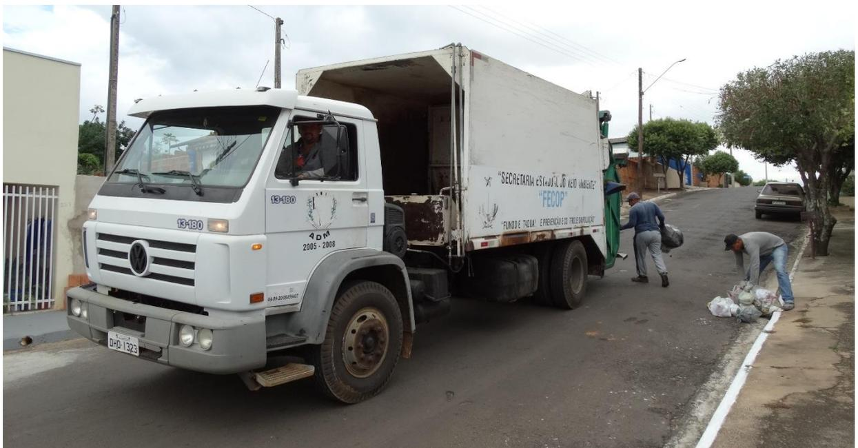
Imagem 8 – Caminhão compactador Volkswagen 13180 (placas DHO-1323), utilizado no serviço de coleta convencional.
