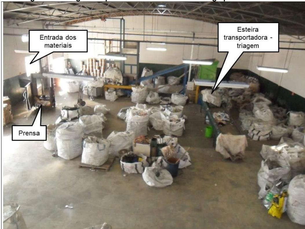
Inicialmente, os materiais recicláveis coletados são retirados do caminhão que realiza a coleta seletiva, Figura 30. Após é realizada a triagem dos materiais na esteira transportadora, Figura 31.
