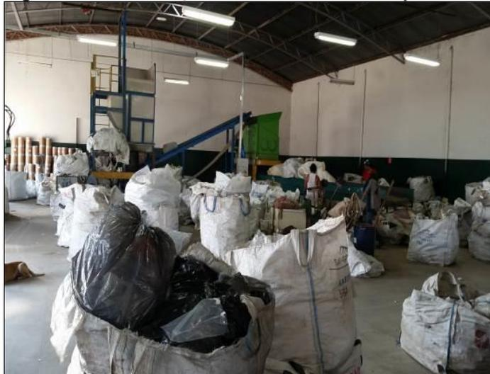
Nas esteiras ocorre a etapa inicial de triagem, onde cada material reciclável é separado e colocado em *bags* de acordo com o tipo de material. Nesta linha cada trabalhador é responsável pela separação de um material específico.
