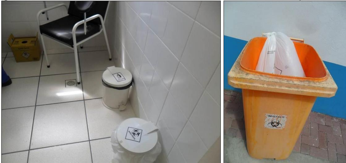
Na unidade de saúde Ponte Nova pode-se observar que o acondicionamento interno dos RSS é realizado de forma adequada. Porém, com relação ao armazenamento externo, não existe na unidade um abrigo de resíduos, sendo os mesmos armazenados em contentor específico com identificação, no entanto sem tampa e em lugar com livre acesso de pessoas.
