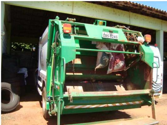
FOTO DO CAMINHÃO COLETOR-COMPACTADOR
