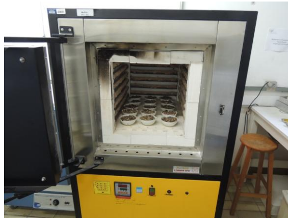
Figura 9: Amostra de resíduos domiciliares em mufla para a realização do ensaio de teor de matéria orgânica
