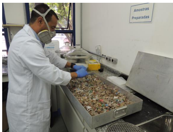
Figura 8: Amostra de resíduo domiciliares triturada e peneirada em malha de 9,5 mm
