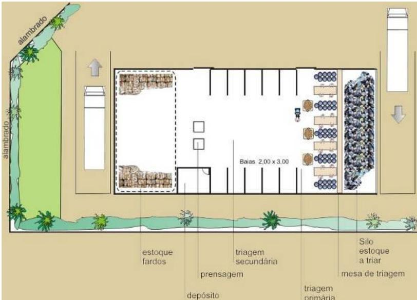
Figura 02 - Modelo de layout do Galpão de Triagem.
