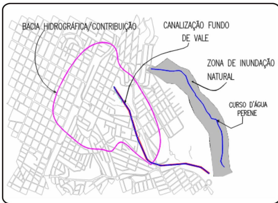
Figura 24: Esquema ilustrativo de macrodrenagem.
