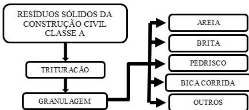
Figura 90 – Fluxograma de reciclagem dos RCC
