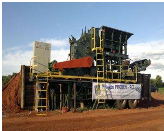
FIGURA 19: Equipamento de beneficiamento de resíduos da construção civil.
