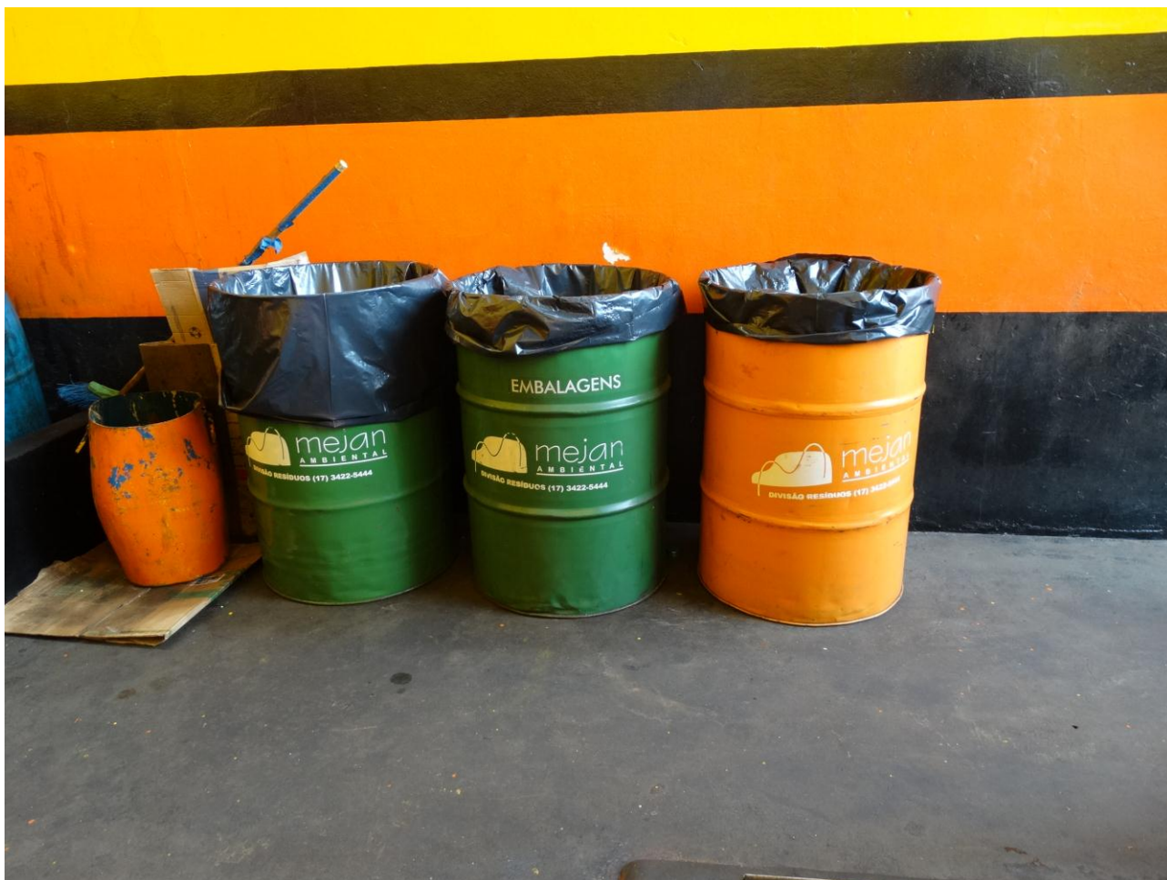
Imagem 39 – compartimentos para acondicionamento temporário de estopas, filtros de óleo e embalagens vazias de lubrificantes. Estes tambores são encontrados nos postos de combustíveis e oficinas que oferecem o serviço de troca de óleo e engraxamento.
