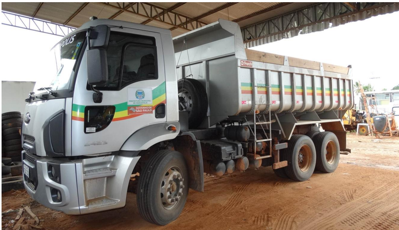
Imagem 38: Caminhão basculante utilizado no serviço de coleta de RCC.
