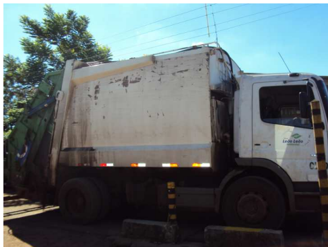
Figura 04 – Caminhão coletor com capacidade de 5m 3 , utilizado no período diurno em Matão
