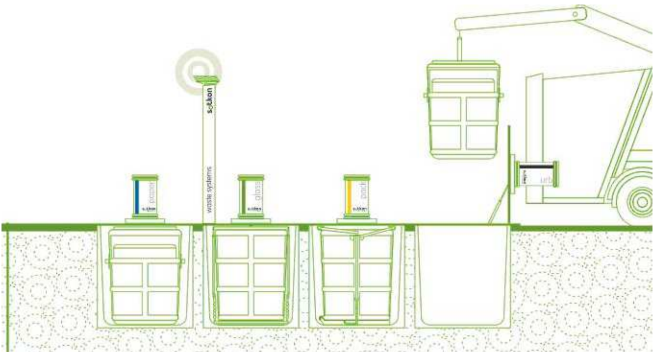
Figura 09 — Sistema de containers subterrâneos Fonte: G1.Globo.com, 2010
