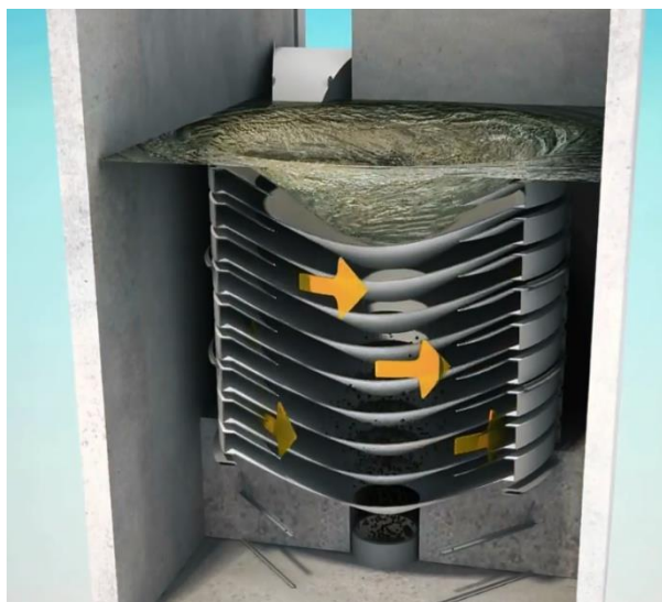
Figura 4 – Desenho esquemático desarenador
