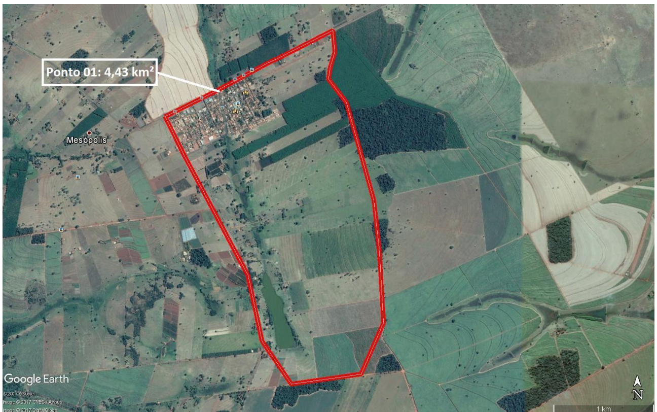
Figura 4.2 – Ponto crítico 01 indicado pelo GEL e respectiva área estimada pelo Google Earth da bacia de contribuição do sistema de macrodrenagem
