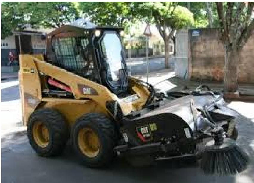
Figura 20: Imagem: Exemplo de Máquina utilizada para varrer rua.
