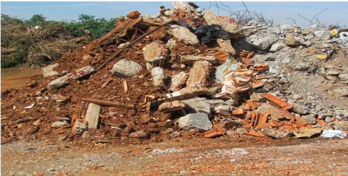
Figura 29: Resíduos de Construção Civil Classe A.
