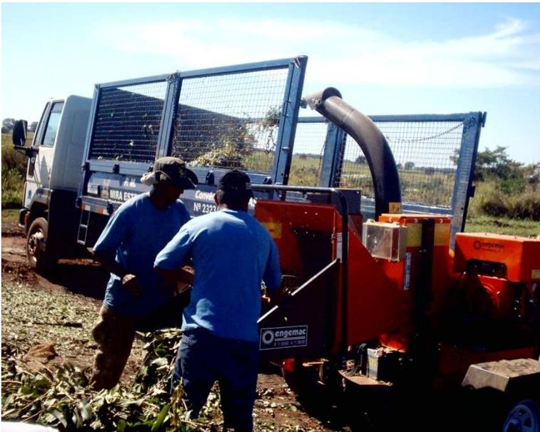
Figura 2- Equipamento Triturador de Galhos das Podas das Arvores.
