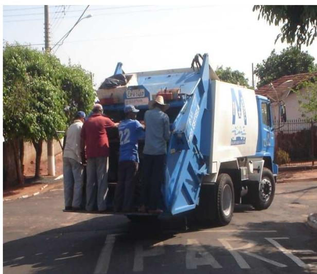
Foto – caminhão de coleta de lixo com caçamba compactadora.
