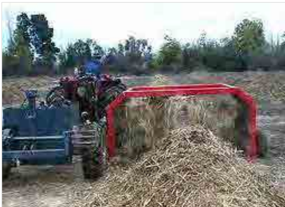
Figura 1.13 – Reviradeira de leira de compostagem acoplada a trator Fonte: Ministério do Meio Ambiente (BRASIL, 2010).
