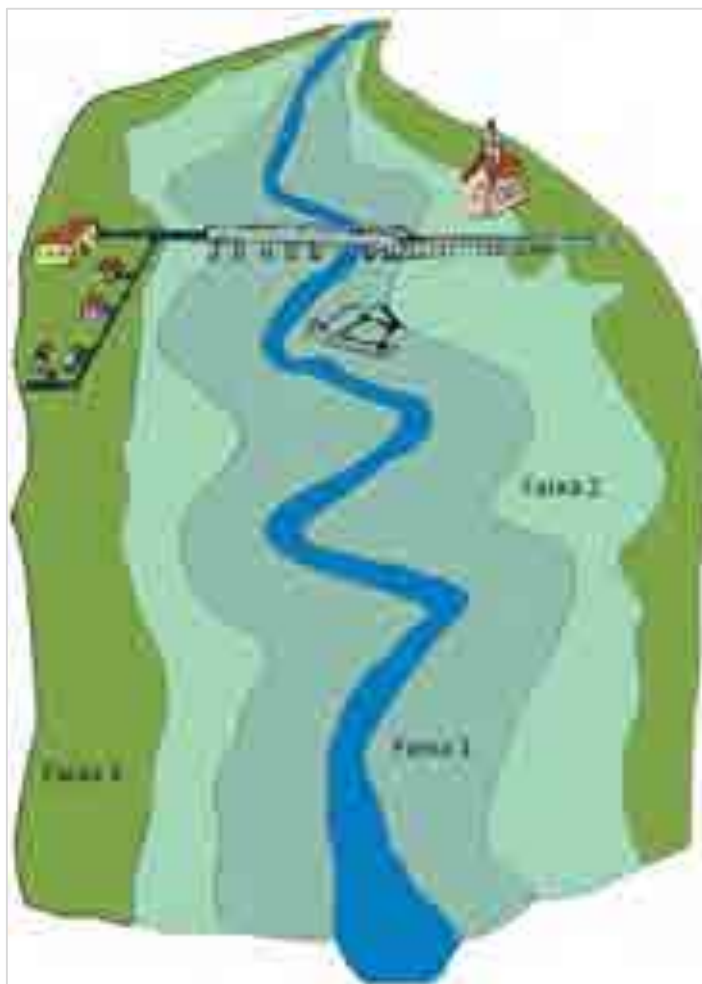
Figura 1.9 – Esquema de regulamentação das áreas alagáveis Fonte: SMDU (2012)
