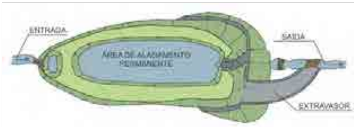
Figura 1.3 – Bacias de retenção alagadas
