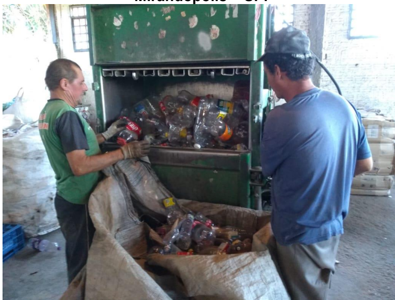
Figura 2.26 – Compactação dos resíduos da Cooperativa Global de Reciclagem de Mirandópolis – SP.
