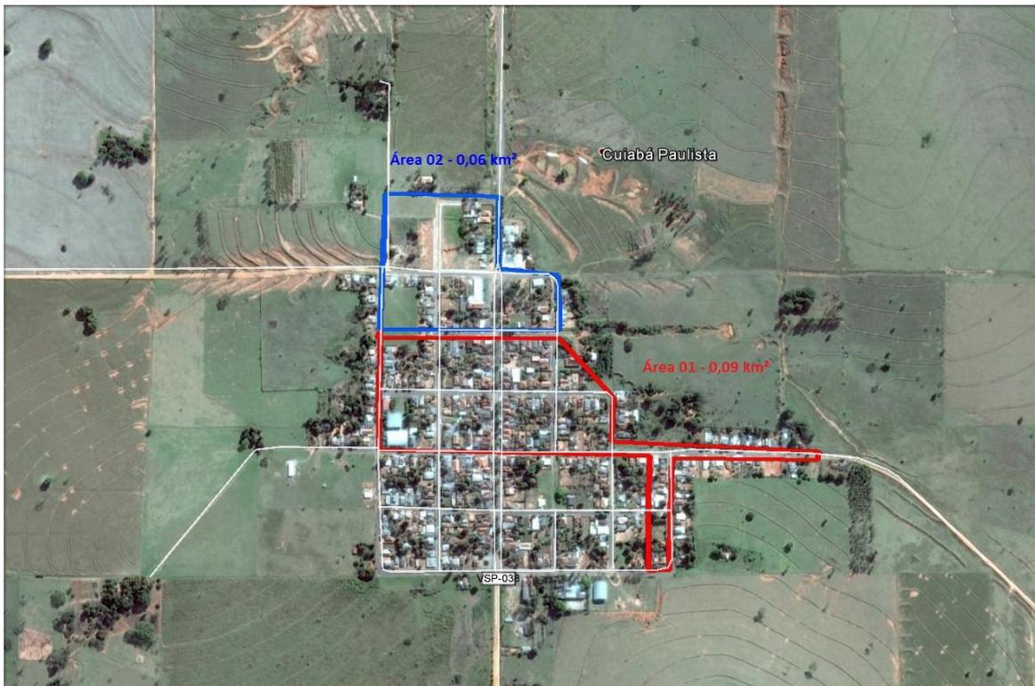
**Figura 4.2 – Pontos críticos do sistema de microdrenagem**
