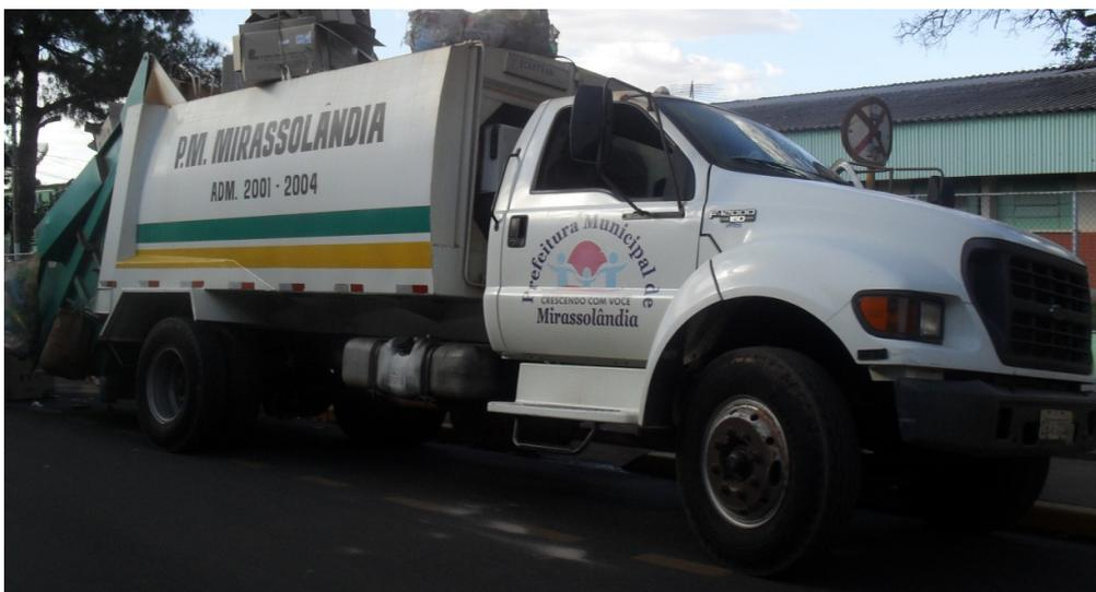
**Figura 02:** Caminhão compactador utilizado na coleta dos resíduos domiciliares.
