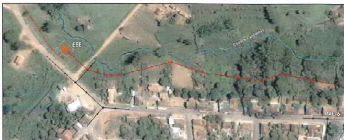
Figura 37 - Croqui de localização da ETE e da linha de recalque - Igarai
