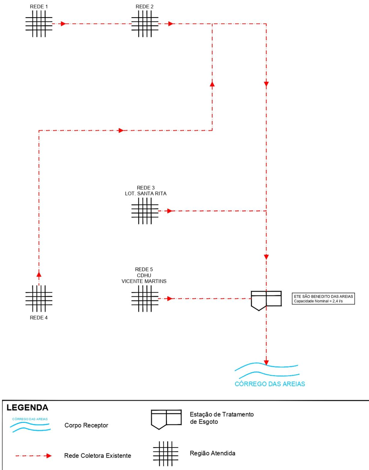
Figura 4.6 – Croqui do Sistema de Esgotamento Sanitário Existente – Distrito São Benedito das Areias
