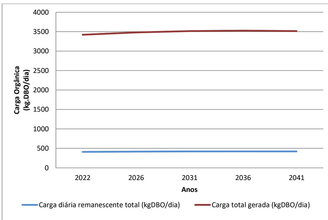
**Gráfico 8.7 - Evolução de Cargas Orgânicas (Kg DBO<sub>5</sub>/Dia)**
