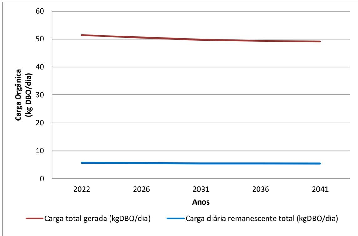
**Gráfico 8.11 - Evolução de Cargas Orgânicas (Kg DBO<sub>5</sub>/Dia)**
