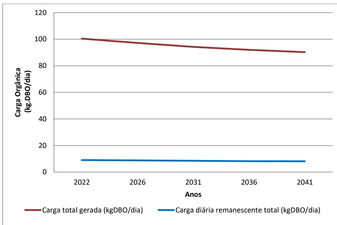
**Gráfico 8.9 - Evolução de Cargas Orgânicas (Kg DBO<sub>5</sub>/Dia)**
