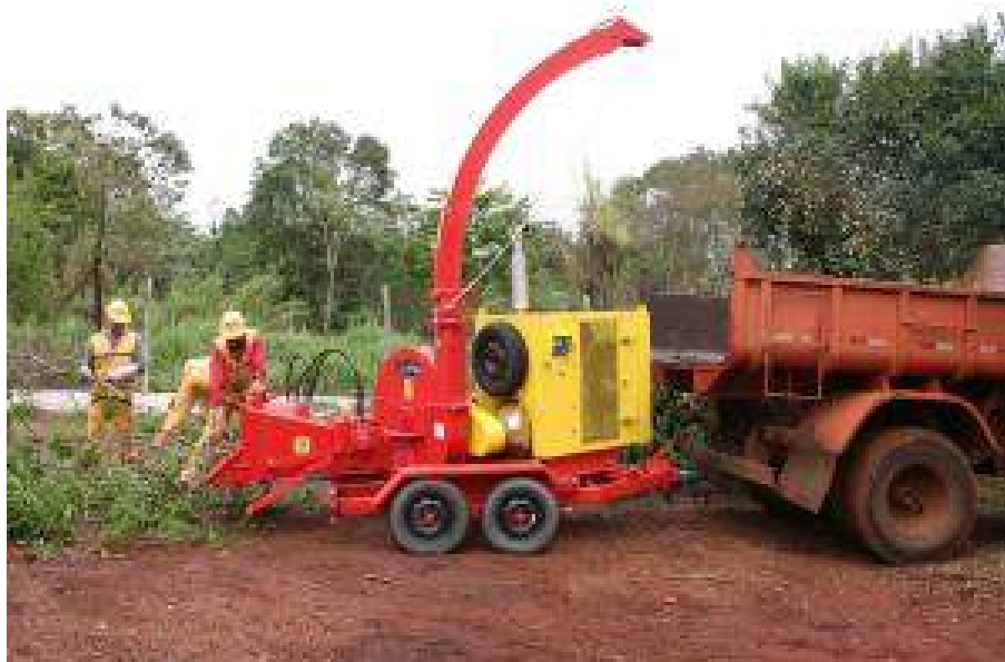
Foto 31 – Triturador de Galhos Rebocado
