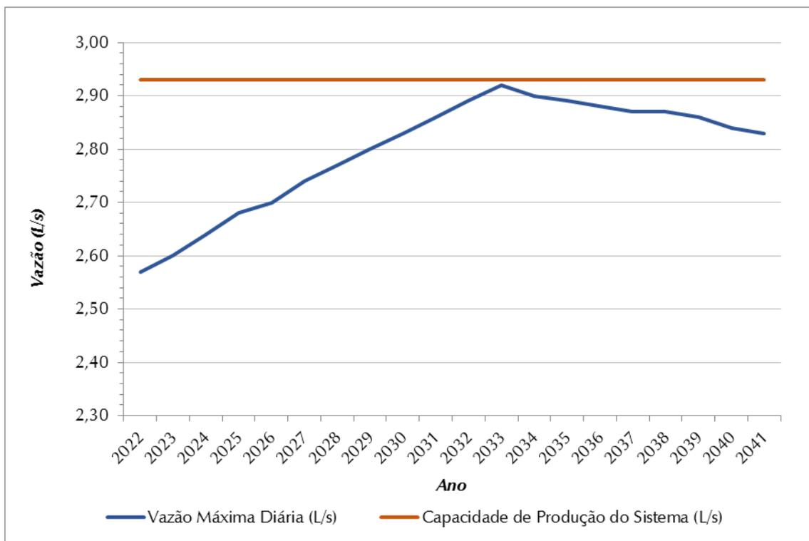
Figura 8.3 – Demandas Máximas Diárias (L/s) X Vazão Captada (L/s) – SAA Ida Iolanda
