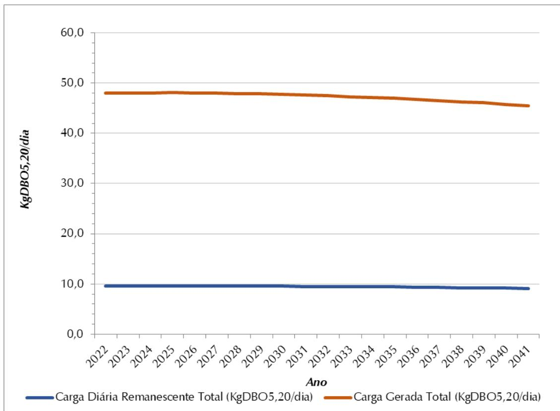
**Figura 8.8 - Evolução de Cargas Orgânicas (Kg DBO<sub>5</sub>/Dia) – SES Ida Iolanda**
