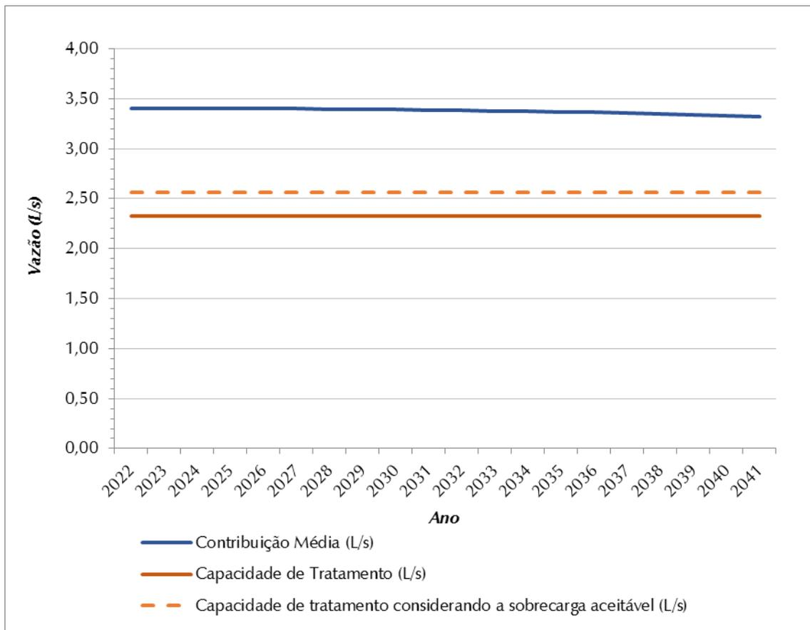
Figura 8.7 – Contribuição Média Total (L/s) x Capacidade de Tratamento de Esgoto (L/s) – SES Ida Iolanda
