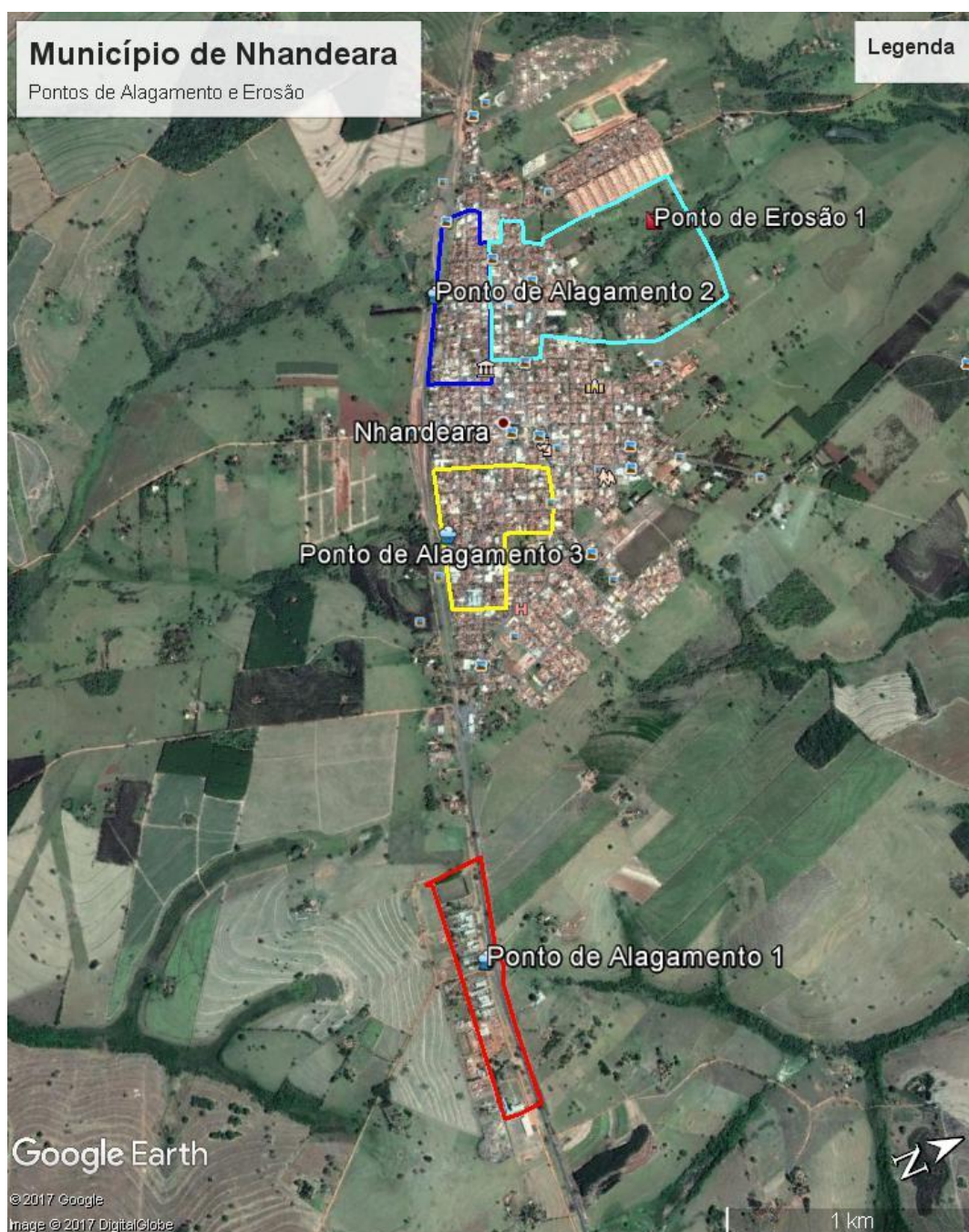
Figura 4.1 – Pontos críticos do sistema de microdrenagem
