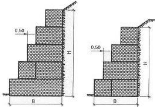
**Ilustração 8.1 – Contenção com gabião tipo caixa**
