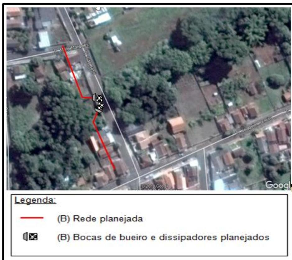
Ilustração 8.1 – Esquema de Solução Proposta para o Ponto 1
