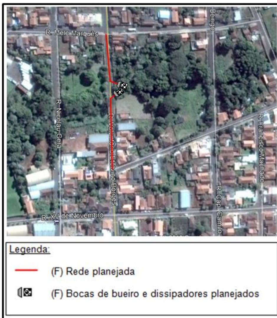
**Ilustração 8.13 – Esquema da solução proposta para o Ponto 3**
