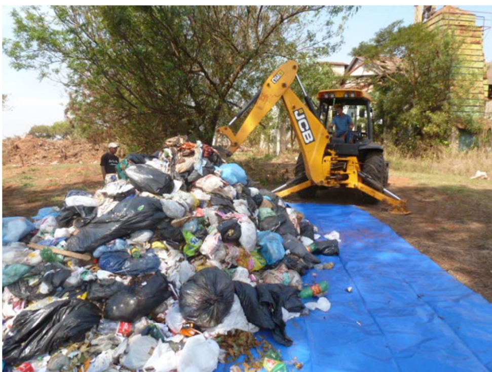
Figura 6. Detalhe da retroescavadeira criando a amostra de resíduos domiciliares para sua caracterização física.
