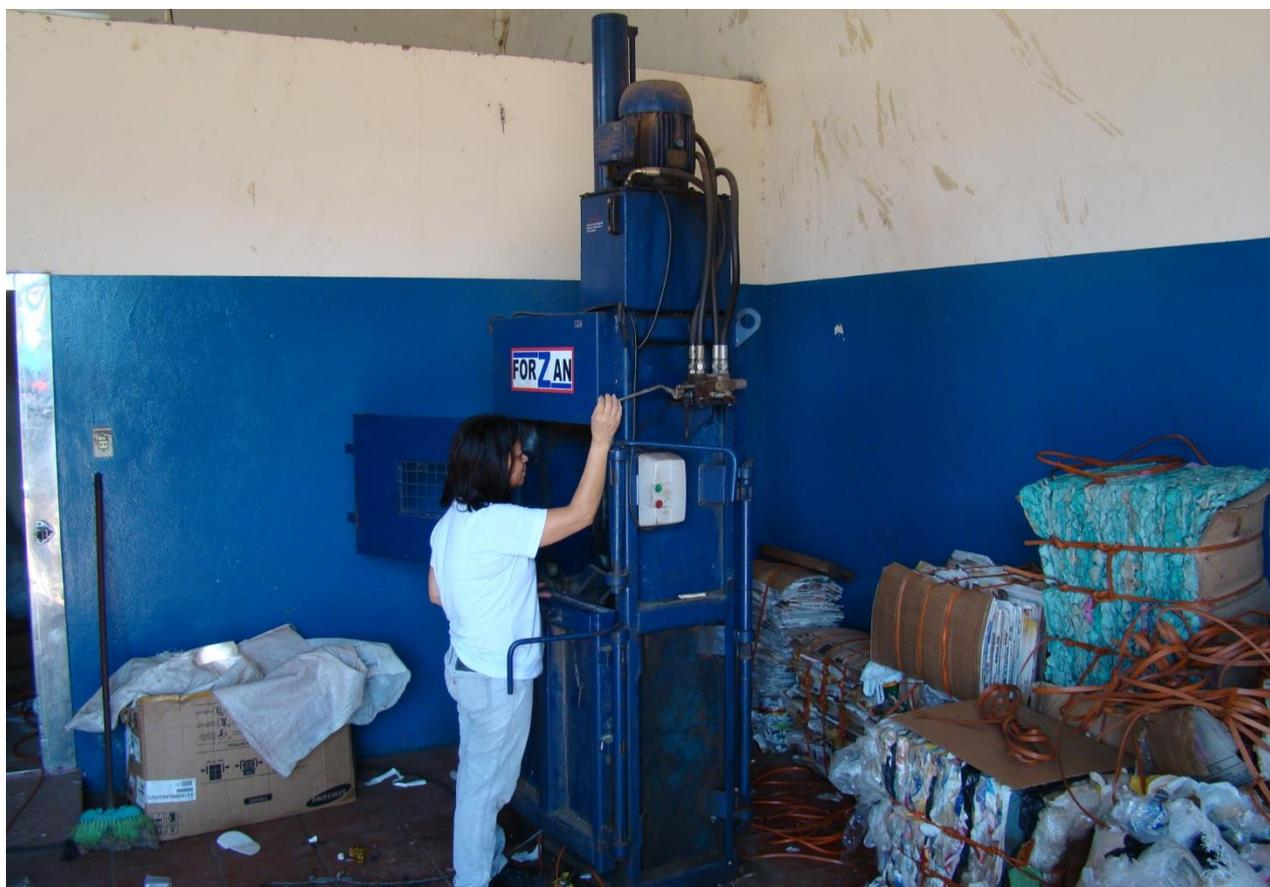
Imagem 26: Modelo de prensa para a compactação e enfardamento dos materiais recicláveis após sua separação.
