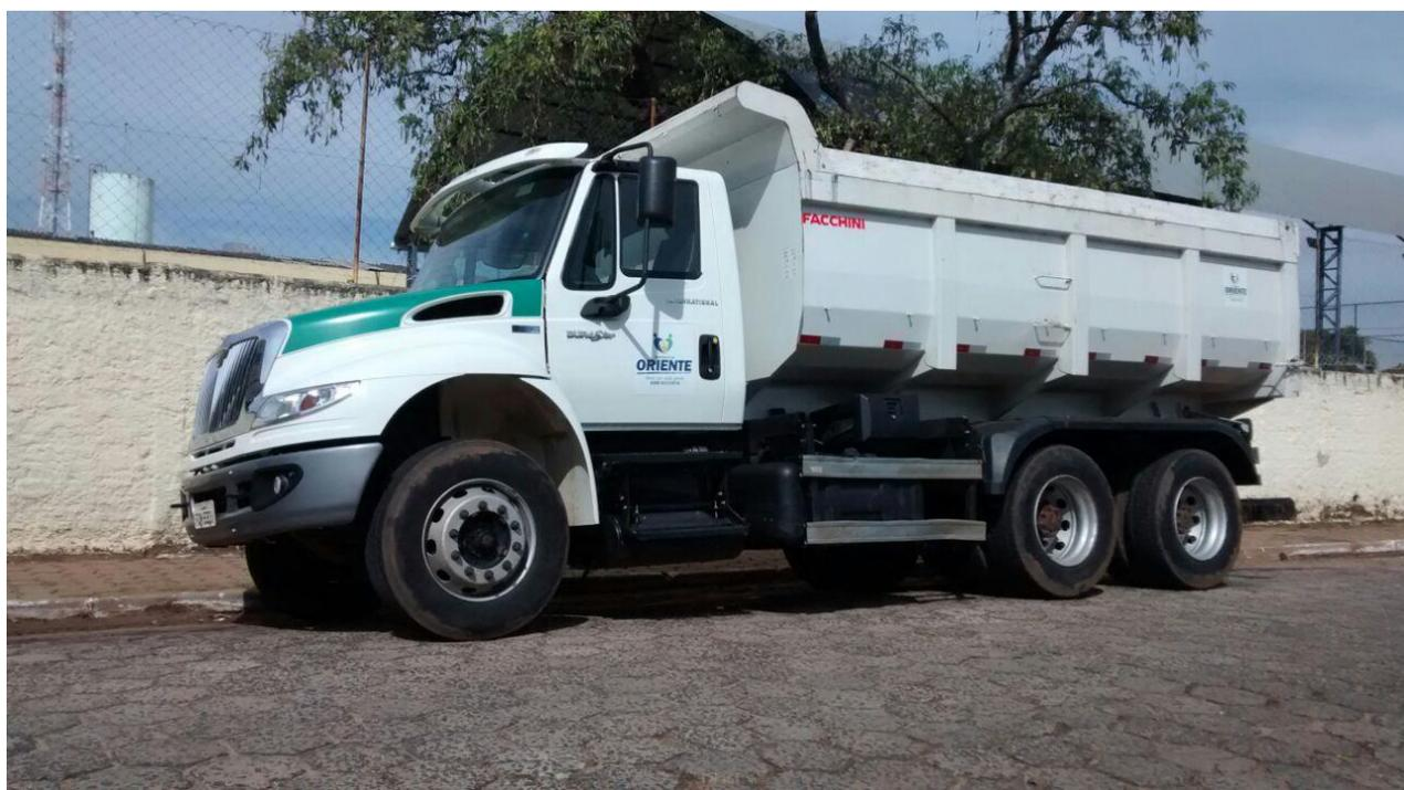
Imagem 35: caminhão basculante utilizado na coleta de resíduos da construção civil.
