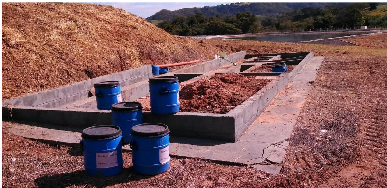
Imagem 46 – lodo originado do esgoto sendo secado e acondicionado em tambores.
