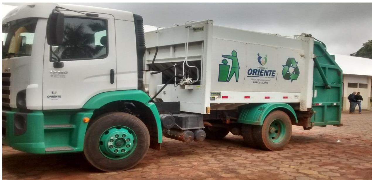
Imagem 9 – Caminhão compactador Volkswagen Constelacion 13180, ano 2010 (placas DBA-6911), utilizado no serviço de coleta convencional.
