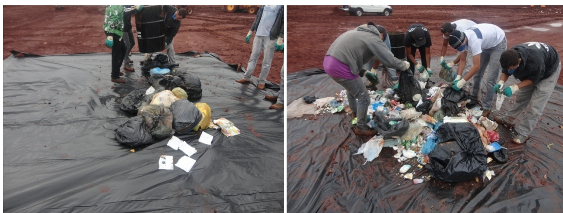
Figura 10. Disposição dos resíduos sobre a lona e retirada dos sacos e sacolas
