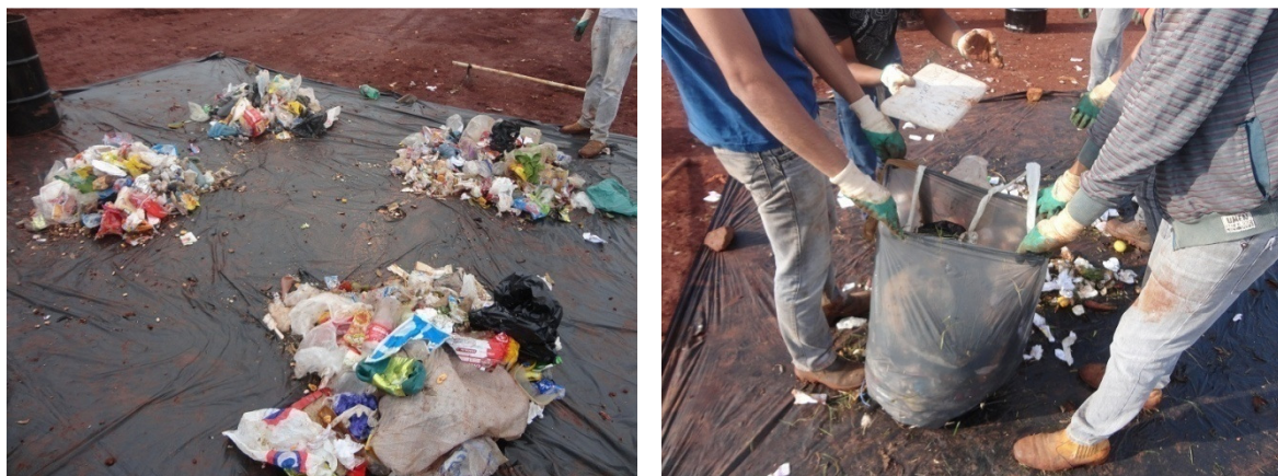
Figura 12. Quarteamento e armazenamento da amostra final resultante de cada caminhão
