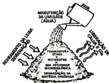
Figura 40. Condições ambientais ótimas para compostagem
