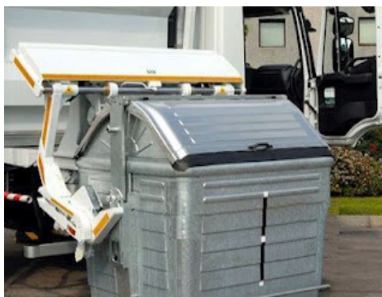
Figura 34. Exemplo de coleta containerizada automatizada com basculamento lateral
