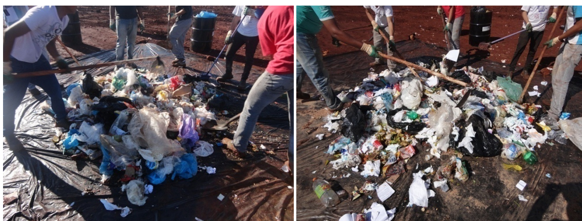
Figura 11. Homogeneização dos resíduos
