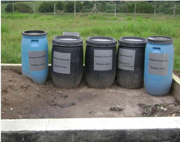
FIGURA 14: Resíduos do gradeamento armazenado.
