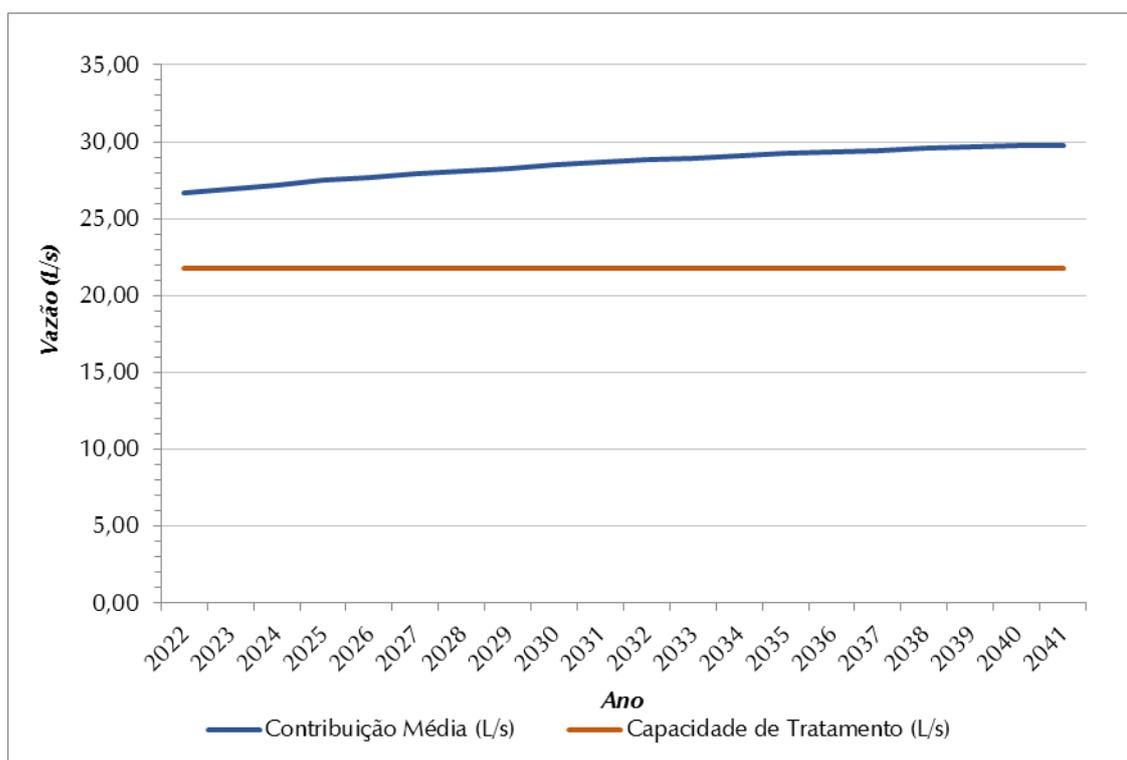
Figura 8.4 – Contribuição Média Total (L/s) x Capacidade de Tratamento de Esgoto (L/s) – SES Sede
