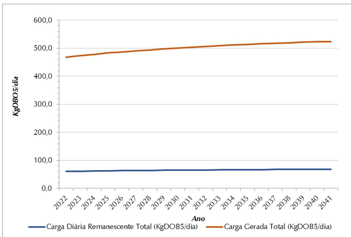
**Figura 8.5 - Evolução de Cargas Orgânicas (Kg DBO5,20/Dia) – SES Sede**
