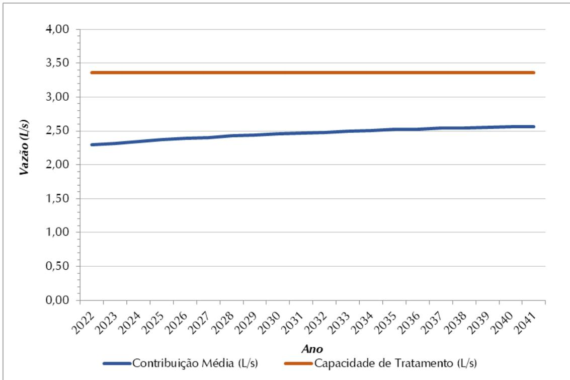
Figura 8.6 – Contribuição Média Total (L/s) x Capacidade de Tratamento de Esgoto (L/s) – SES Arabá
