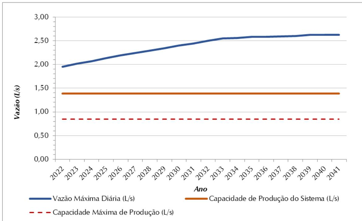
**Figura 8.2 – Demandas Máximas Diárias (L/s) X Vazão Captada (L/s) – SAA Arabá**
