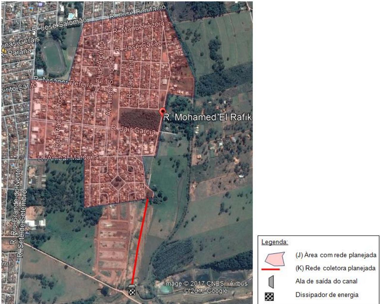
**Ilustração 8.13 – Esquema das soluções propostas para os Pontos P04 e P05**
