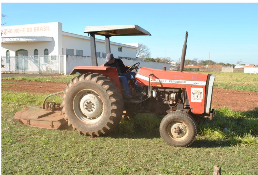
Foto 28 - Funcionário realizando capina motorizada, com roçadeira acoplada em trator agrícola
