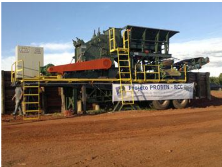
Foto 31 - Máquina de Beneficiamento de RCC – Fonte: CIVAP
