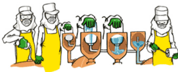
Figura 11 - Esquema de Lavagem sob Pressão - fonte: inPEV
