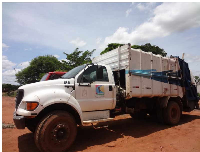
Foto 20 - Caminhão-compactador responsável pela coleta de resíduos doméstico de Paraguaçu Paulista/SP.
