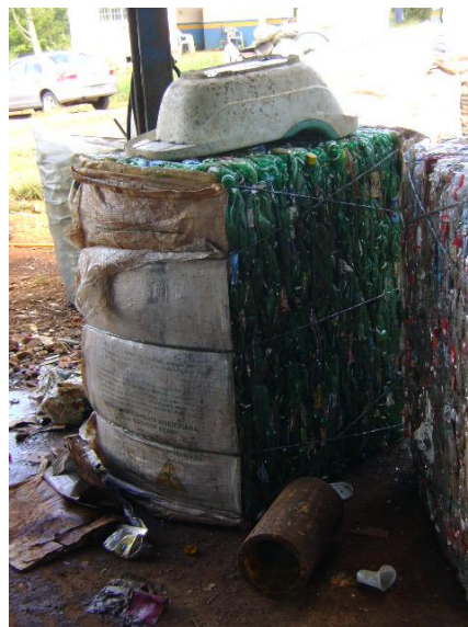
FOTO 4.26– DETALHE DAS GARRAFAS PET DEPOIS DE PRENSADAS
