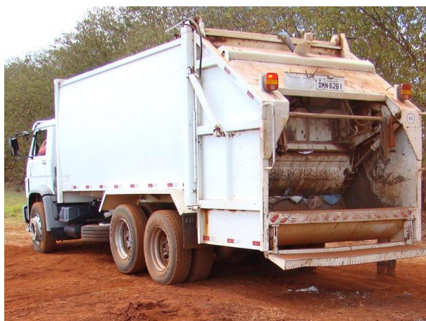
Foto 2. Caminhão de Coleta de RSU e a caçamba compactadora.
