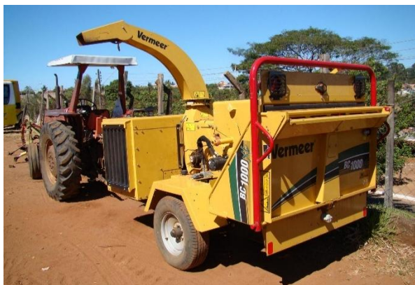
Foto 18. Triturador utilizado para trituração de resíduos vegetais.
