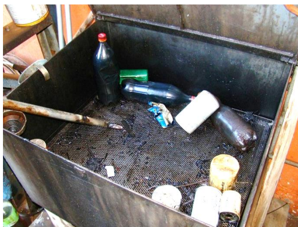
Foto 73. Coletor de óleo de filtros.
