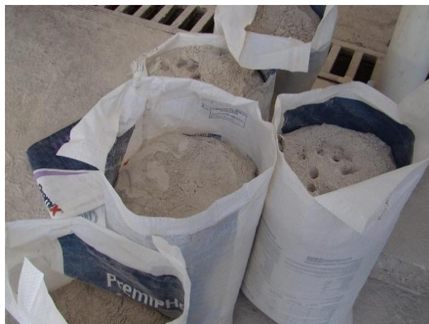
Foto 60. Pó acumulado dos exaustores (Caulim).
