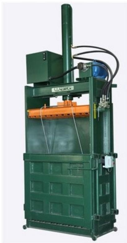
Figura 21 – Prensa Utilizada na Prensagem e Compactação dos Resíduos.
