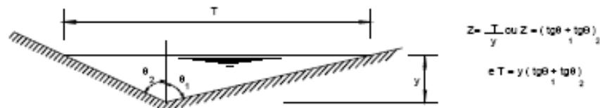
3) - PARA SEÇÕES COMPOSTA, DEVE-SE CALCULAR A SOMA ALGÉBRICA DAS VAZÕES EM CADA UMA DAS SEÇÕES TRIANGULARES COMPONENTES, CONFORME EXEMPLO A SEGUIR:
