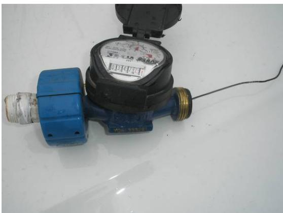
Figura 07. Hidrômetro com arame
