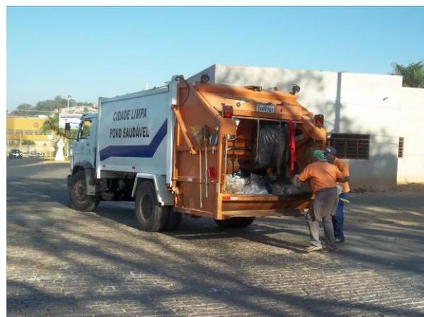
Figura 151. Caminhão Compactador durante a coleta
