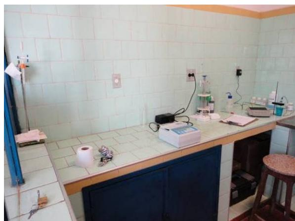
Figura 85. Turbidímetro existente no laboratório do SAAE
