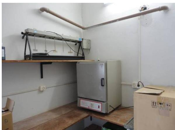
Figura 88. Equipamento de Jar-Test e Estufa existente no laboratório do SAAE
